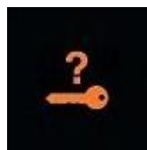
۱۴. **Key Not In Vehicle** : چراغ هشدار نبودن کلید در اتومبیل
