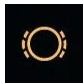
: چراغ اخطر اتمام لنت ترمز **Brake Pad Warning**.<sup>۵</sup>
