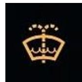
: چراغ کم بودن سطح آب شیشه شور **Washer Fluid Low**.<sup>۴</sup>
