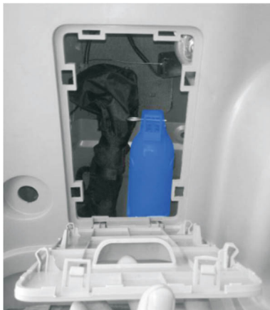
◀ شکل ۱۵۴ محل کپسول آتش‌نشانی
