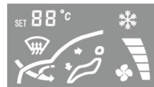
شکل ۷۱ LCD کنترل تهویه مطبوع
