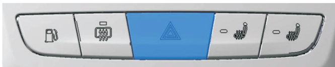
◀ شکل ۳۱ تا بلو فرمان: کلید هشدار چشمک می‌زند
