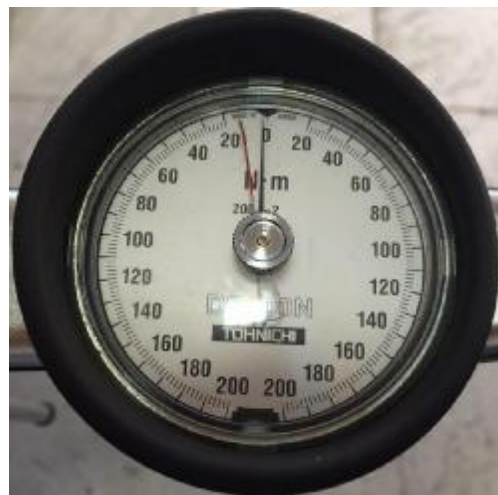
وضعیت قرارگیری عقربه قرمز رنگ (Stopper) در حالت اولیه قبل از مبادرت به بازکردن پیچ
