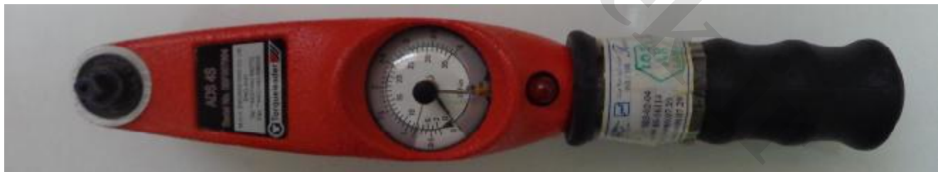
تصویری از یک TorqueMeter - بازه اندازه گیری: 0 تا 4 N.m
