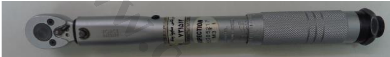
تصویری از یک Torquewrench - بازه کارکرد: 25 N.m
