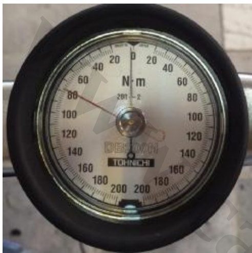
وضعیت قرارگیری عقربه قرمز رنگ (Stopper) پس از بازشدن پیچ
