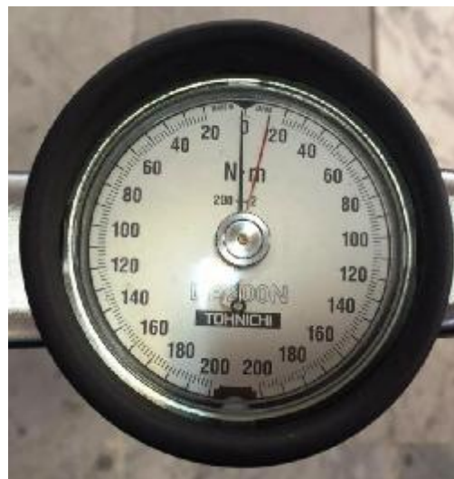
وضعیت قرارگیری عقربه قرمز رنگ (Stopper) در حالت اولیه قبل از مبادرت به سفت کردن پیچ
