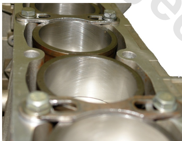
نمایی از نحوه قرار گرفتن بوش بند بر روی بلوکه سیلندر
