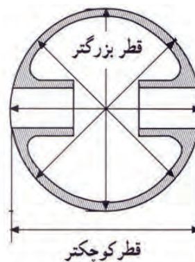
شکل ۷. اندازه قطر های پیستون
