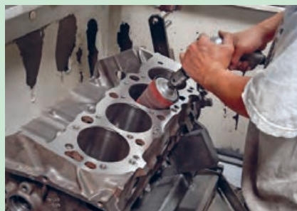
شکل ۳۹. ترمیم لبه بالای سیلندر
