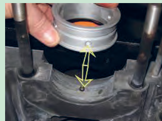
شکل ۹۳. قرار گرفتن سوراخ روغن مقابل هم
