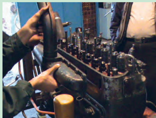
شکل ۴۳. باز کردن مانیفولد تراکتور U650
