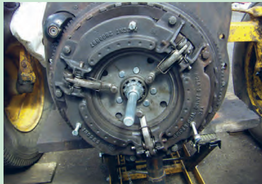
شکل ۳۷. سوار کردن مجموعه کلاچ روی فلاپیول
