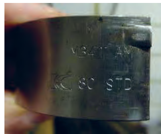
شکل ۲۳. تغییر ضخامت یاتاقان در سایزهای مختلف
