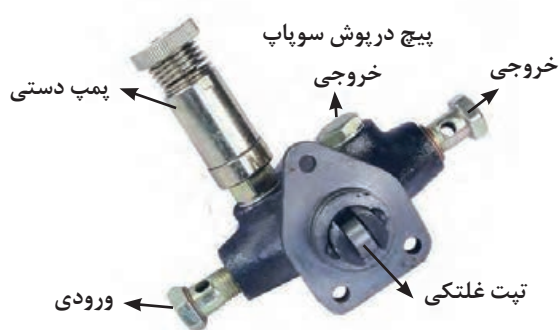
شکل ۲۳. پمپ پیستونی و موقعیت آن روی پمپ انژکتور
