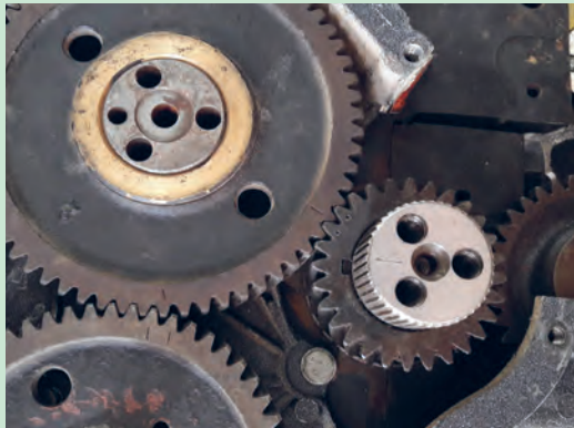
شکل ۱۰۹. علامت‌های تایمینگ روی چرخ دنده ها
