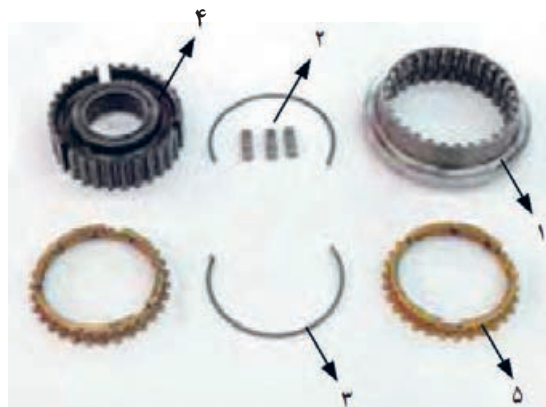
۱- کشویی، ۲- خار، ۳- فنرهای حلقه‌ای، ۴- توپی، ۵- دنده برنجی (حلقه سنکرونیزه)
