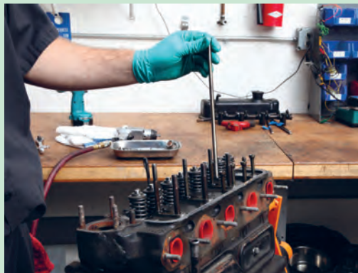
شکل ۴۷. خارج کردن میل تپت‌ها
