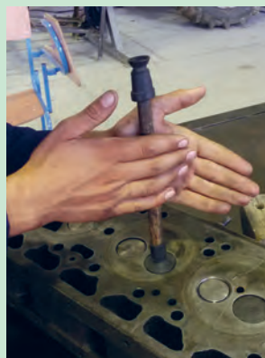
شکل ۷۹. چرخاندن سوپاپ به وسیله چوب سوپاپ گردان
