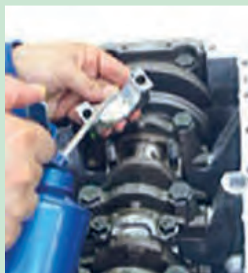
شکل ۱۰۱. روغن کاری کپه یاتاقان شاتون
