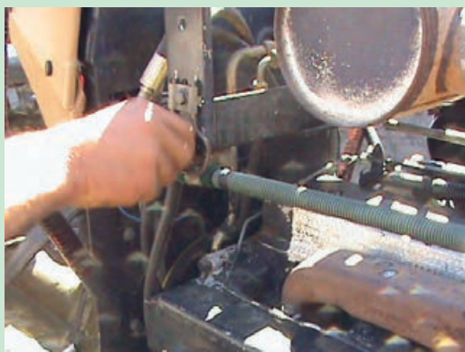
شکل ۴۱- باز کردن انباره اگزوز تراکتور MF۳۹۹
