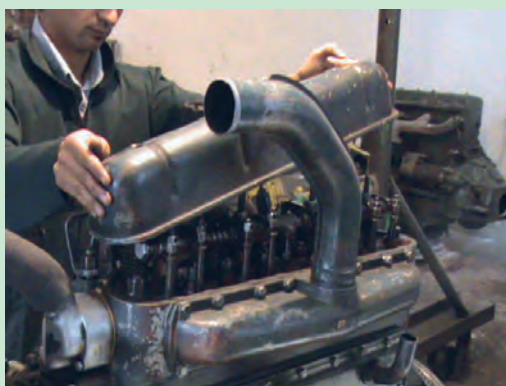
شکل ۴۴. برداشتن درپوش سوپاپ‌های تراکتور U650
