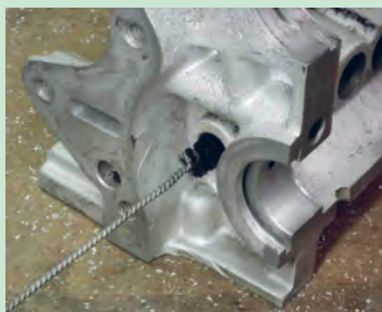
شکل ۵۹. تمیز کردن مجاری آب و روغن
