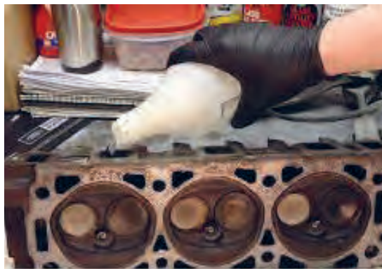
شکل ۷۴. ریختن نفت در سرسیلندر برای کنترل آب‌بندی سوپاپ‌ها
