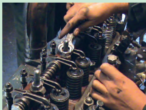
شکل ۴۵. باز کردن پیچ‌های پایه اسبک
