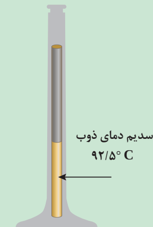
شکل ۲۶. سوپاپ سدیمی
