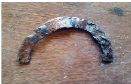
شکل ۷۳. نمونه بغل یاتاقانی معیوب
