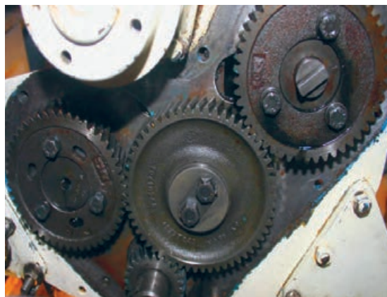
شکل ۲۷. چرخ دنده‌های تایمینگ در سینی جلو موتور
