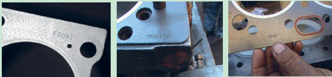
شکل ۸۶. علامت های روی واشر سرسیلندر
