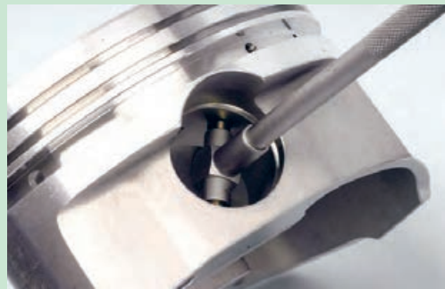
شکل ۸۱. اندازه گیری لقی گزن بین در پیستون
