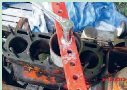
شکل ۹۰. جا زدن بوش با ابزار
