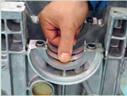
شکل ۵۰. برداشتن یاتاقان های ثابت و بغل یاتاقانی
