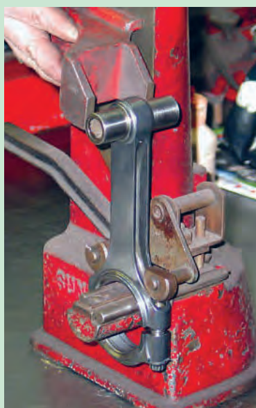
شکل ۸۲. پیچیدگی شاتون، اندازه گیری و اصلاح آن
