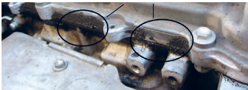
شکل ۲۷. نشتی روغن از درپوش سوپاپ‌ها
