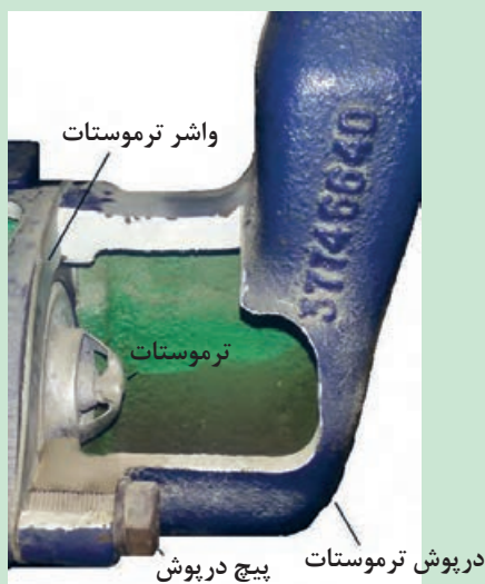
شکل ۱۷. نمای برش خورده ترموستات تراکتور MF285
