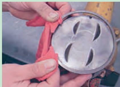
شکل ۵۳. خارج کردن رینگ بدون رینگ بازکن
