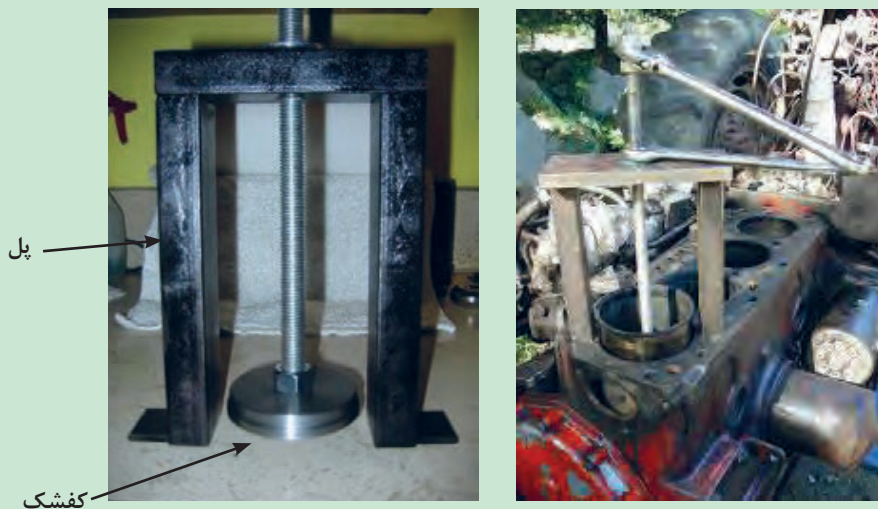
شکل ۵۵. خارج کردن بوش پیستون از بلوکه سیلندر با ابزار بوش کش
