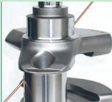
شکل ۶۰. تمیز کردن مجاری میل لنگ
