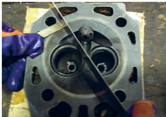
شکل ۶۵. کنترل تابیدگی سرسیلندر تراکتور دوچرخ
