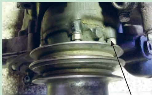
شکل ۱۵. پیچ‌های اتصال پروانه و پمپ آب تراکتور MF۲۸۵
