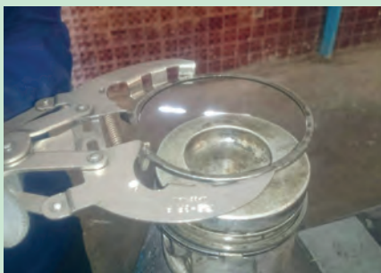
شکل ۵۲. نحوه خارج کردن رینگ از روی پیستون
