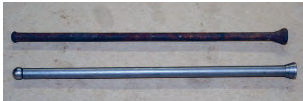
شکل ۷۶. زنگ زدن و شکستگی میل تپت
