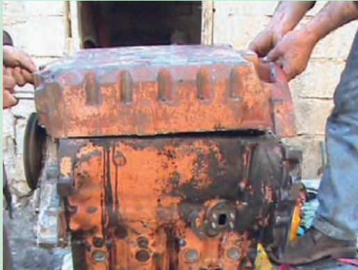
شکل ۱۱۵. نصب کارتر روی بلوکه سیلندر
