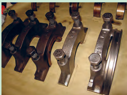
شکل ۴۸. برداشتن کپه های یاتاقان و چیدن آنها
