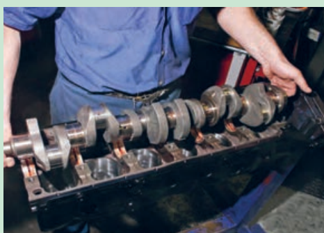
شکل ۴۹. برداشتن میل لنگ
