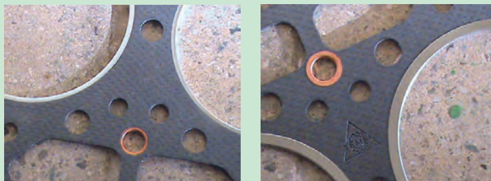
شکل ۸۷. تفاوت ضخامت قسمت های مسی روی واشر سرسیلندر
