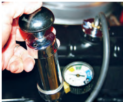
شکل ۶. آزمایش نشت یابی تحت فشار
