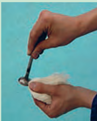
شکل ۸۰. تمیز کردن سوپاپ
