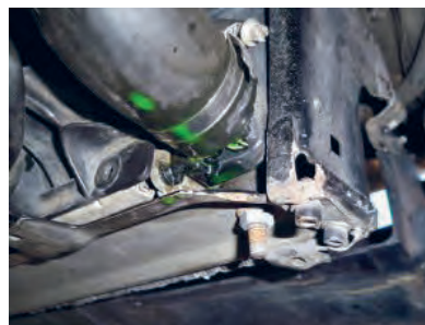
شکل ۵. نشتی از محل اتصالات
