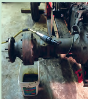
شکل ۳۲. کاهنده نهایی بعد از باز کردن چرخ
