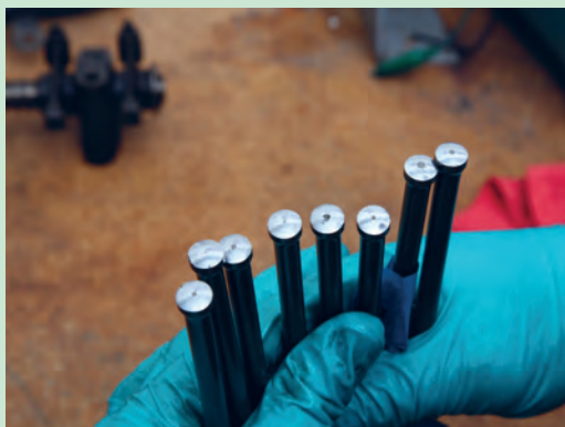
شکل ۴۷. خارج کردن میل تپت‌ها
