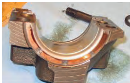
شکل ۷۳. نمونه بغل یاتاقانی معیوب
