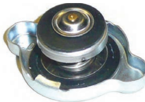
شکل ۱۲. درب رادیاتور و سوپاپ های آن
