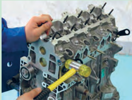
شکل ۴۹. آزاد کردن چسبیدگی سر سیلندر
