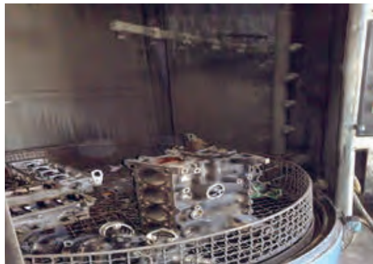
شکل ۶۱. شستشوی موتور به وسیله دستگاه شات بلاست
