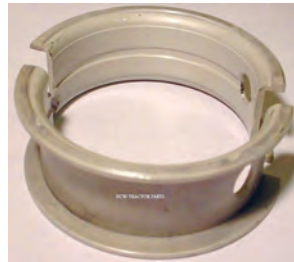
الف- بغل یاتاقانی یک تکه با یاتاقان
