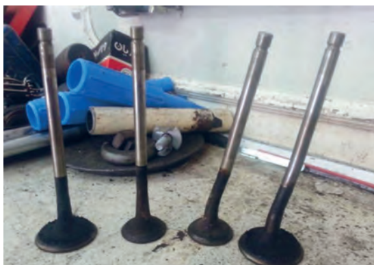
شکل ۶۷. کربن گرفتگی سرسیلندر و سوپاپ‌ها
