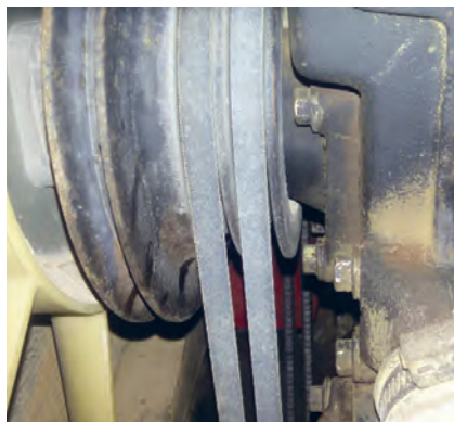
شکل ۷. استفاده از دو تسمه در تراکتور MF۳۹۹
