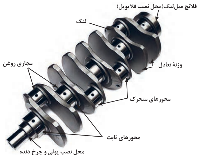
شکل ۱۶. اجزاء میل لنگ
