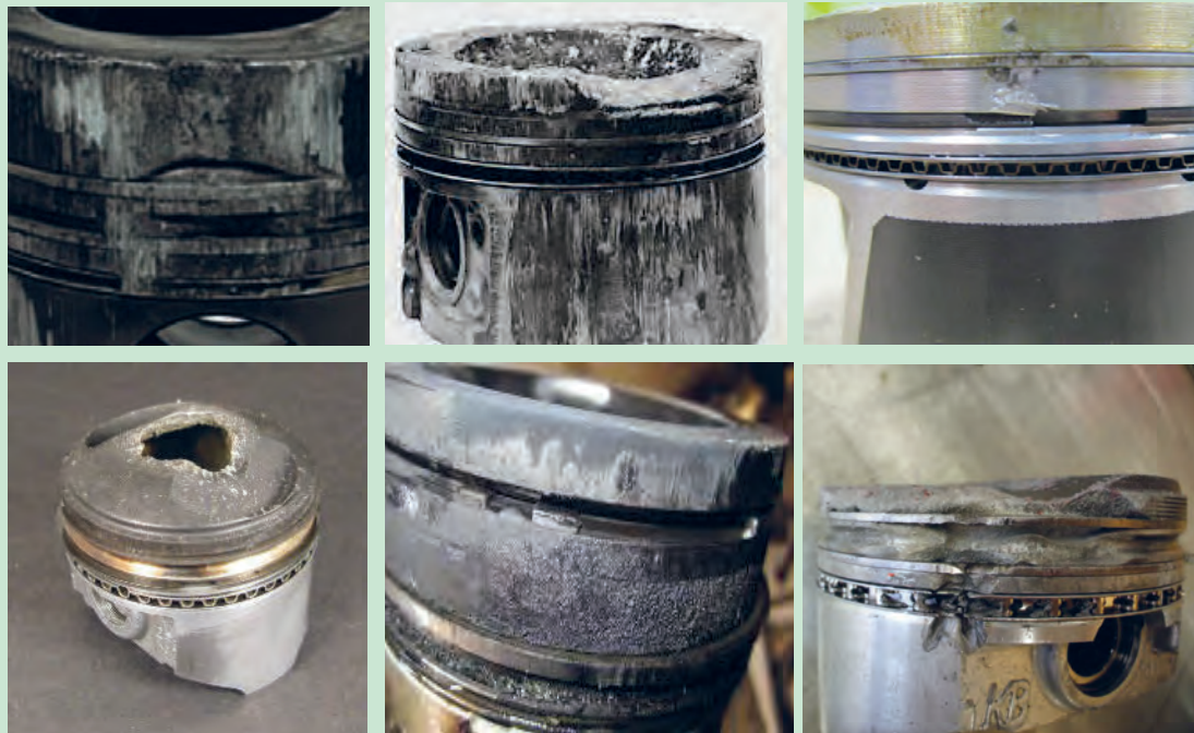
شکل ۷۴. نمونه ای از پیستون های معیوب
