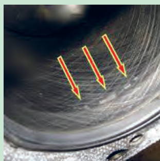
شکل ۶۹. نمونه معایب سطح داخل بوش پیستون
