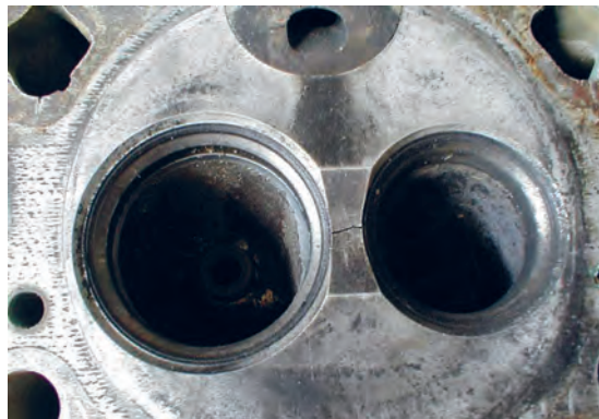
شکل ۶۶. ترک خوردگی سرسیلندر در محفظه احتراق
