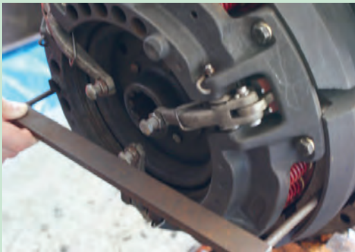
شکل ۳۸. تنظیم انگشتی‌های کلاچ
