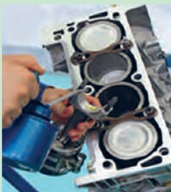
شکل ۱۰۱. روغن کاری کپه یاتاقان شاتون
