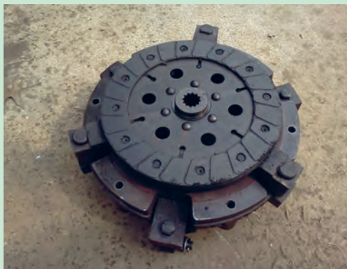
شکل ۲۵. جدا کردن مجموعه کلاچ از فلاپیول
