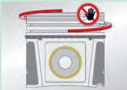
شکل ۵۳. خارج کردن رینگ بدون رینگ بازکن
