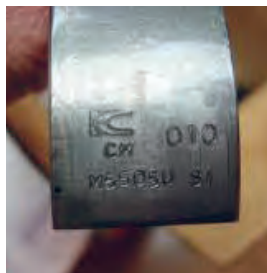
شکل ۲۳. تغییر ضخامت یاتاقان در سایزهای مختلف
