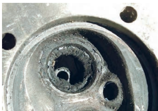
شکل ۶۷. کربن گرفتگی سرسیلندر و سوپاپ‌ها
