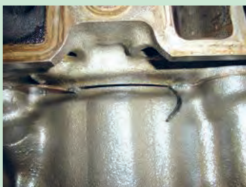
شکل ۶۲. ترک در سیلندر و بلوکه سیلندر
