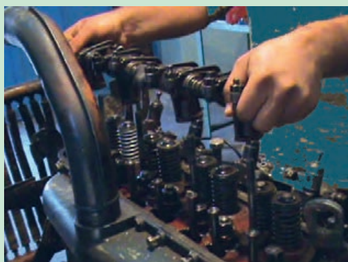
شکل ۴۶. برداشتن مجموعه اسبک از روی سرسیلندر
