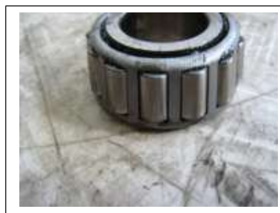
رولبرینگ فاقد گریس که می بایست تعویض گردد
