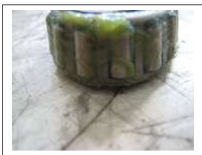
رولبرینگ دارای گریس که نیاز به تعویض ندارد
