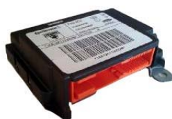
واحد کنترل الکترونیکی
