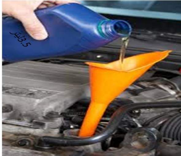
شکل 1-13 مقدار روغن در کارتل پرآید
