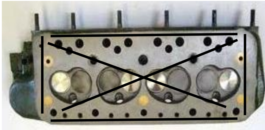
شکل 6-1 روش تاب گیری سر سیلندر
