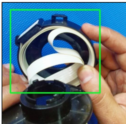
شکل شماره (۹) ایراد تاخوردگی نوار داخلی سویچ چرخشی
