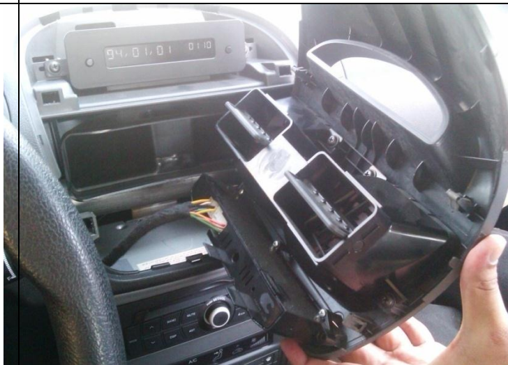
شکل ۱- پانل مرکزی داشبورد و خارج کردن آن از محل خود
