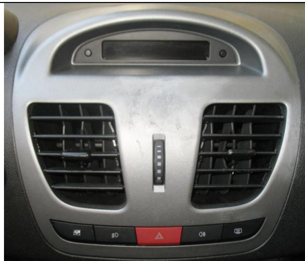
شکل ۱- پانل مرکزی داشبورد و خارج کردن آن از محل خود
