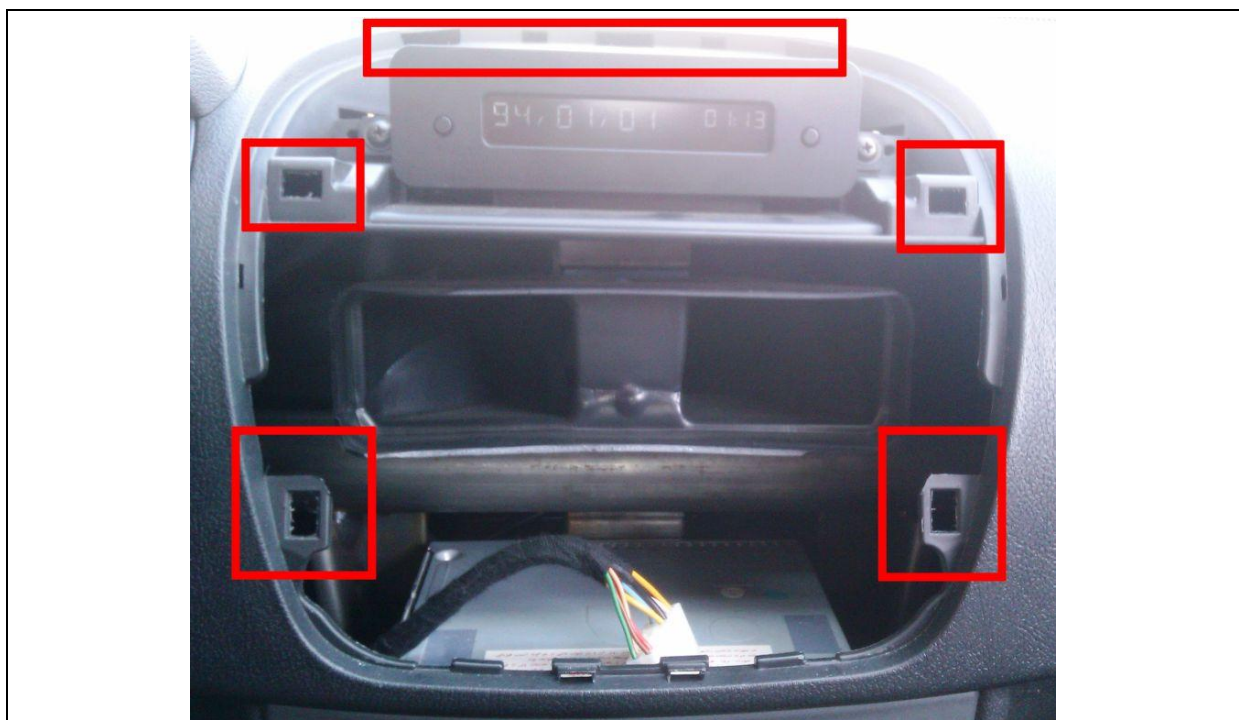
شکل ۱۰ - نصب پانل مرکزی داشبورد و محل قرارگیری خارها
