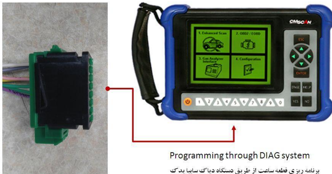
شکل ۷ - اتصال سیم رابط به دستگاه دیاگ سایپا یدک
