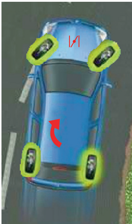
مثال از عملیات تنظیم ESP
