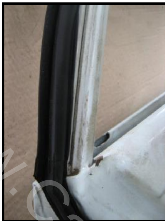
شكل 3- خارج از ريل بودن نوار دور درب
