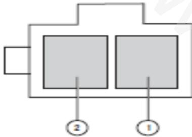
(d) با استفاده از مولتی متر دیجیتالی ، اتصال بین پایه های ۱ و ۲ از بلندگو را بررسی کنید . در صورتی که اتصال برقرار نبود ، بلندگو را تعویض کنید .
