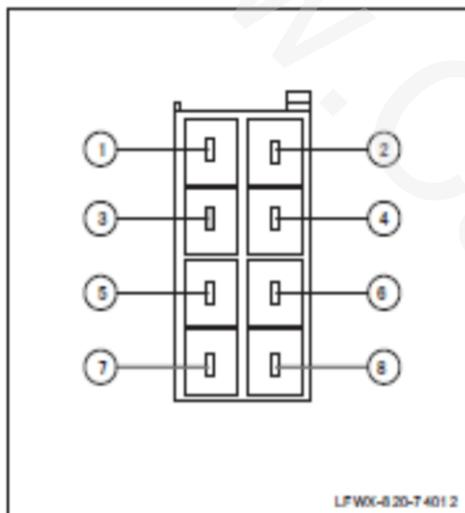
(c) با استفاده از مولتی متر ولتاژ بین پایه ۳ از کانکتور دسته سیم پخش کننده CD و بدنه را بررسی کنید . در صورتی که ولتاژ 0 بود ، دسته سیم را مطابق با نقشه و مونتاز کرده و ایراد را رفع کنید .
