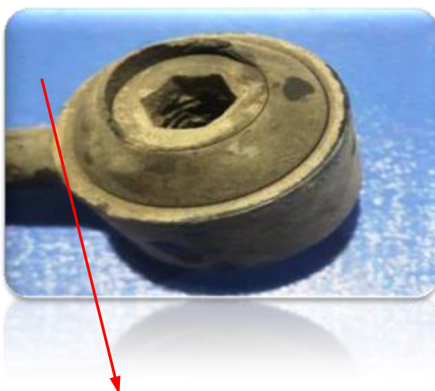
جدایش لاستیک از سطوح فلزی
