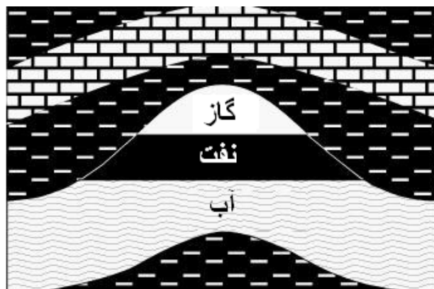
شکل ۱،۱ چگونگی استقرار نفت در لایه های زیرزمینی
