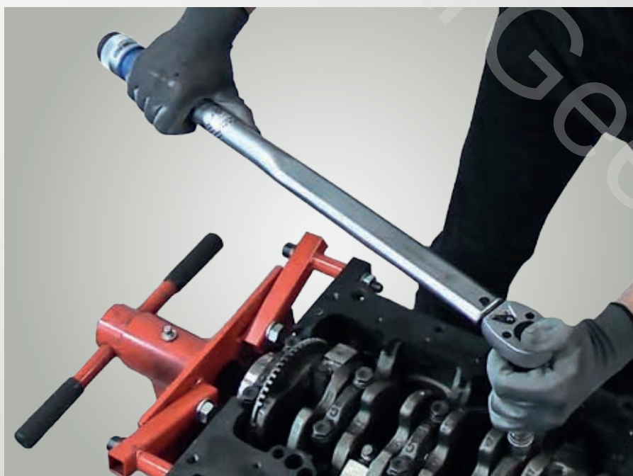
تصویر ۱: کشش پیچ طبق مقررات تولید کنند
