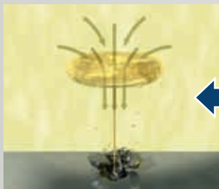
میکروجت با حباب حفره‌زایی می‌شکند و روی سطح ظاهر می‌شود
