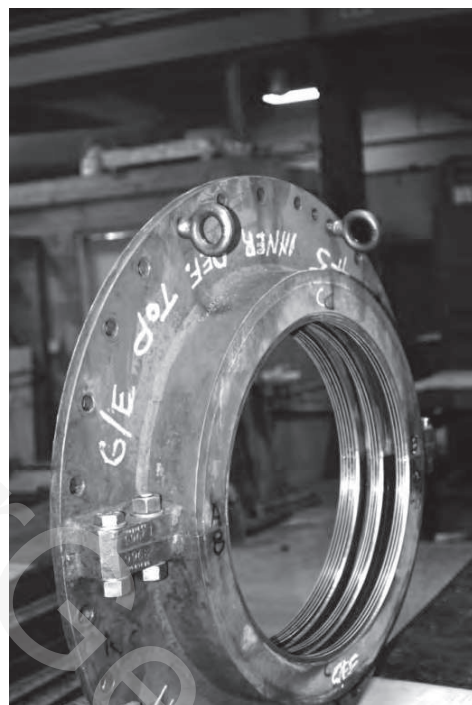
شکل ۷-۴: سیل لاپیرنت آلومینیومی
