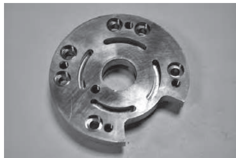
شکل ۱۲-۴: یاتاقان توربو اکسپندر (سرعت دوران ۵۰۰۰۰ دور در دقیقه)
