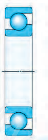
شکل ۱۹ - بلبرینگ با عنصر غلتان سرامیکی.
