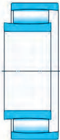
شکل ۲۲ - نمونه‌ای از رولبرینگ توریدال CARB toroidal roller bearing
