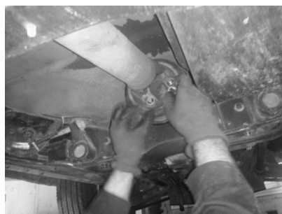
باز کردن ۴ عدد مهره و واشر فنری چهار شاخ گاردان
