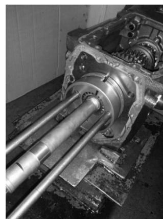
با استفاده از فیسچر دنده ۵ را در بیاورید
