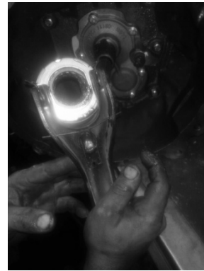
گریس کاری بوش بلبرینگ کلاچ و نشیمنگاه پیچ دو شاخه کلاچ
