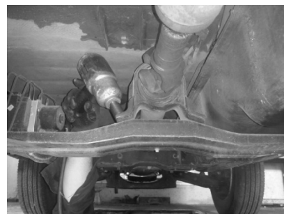
باز کردن پیچهای قفل گاردان
