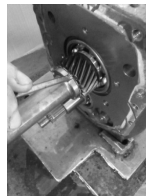
پیچ نگهدارنده دنده ۵ را باز کنید و واشر فنری مربوطه را در
