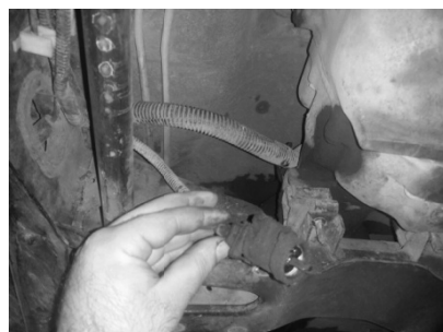
جدا کردن سنسور کیلومتر شمار و سویچ دنده عقب (شمع) از روی گیربکس
