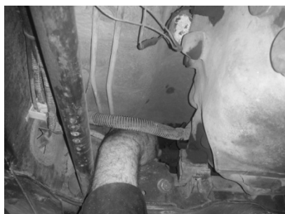
جدا کردن مجموعه گاردان از روی خودرو
