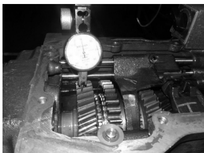
اندازه گیری لقی دنده با استفاده از ساعت اندیکاتور
