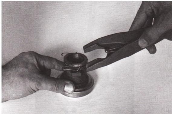
۱ - دو شاخه کلاچ را از فنرهای بوش بلبرینگ کلاچ بیرون بکشید.
