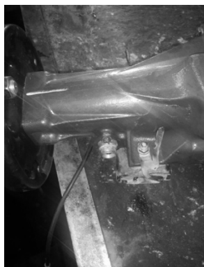
مونتاز مجموعه چوپوقی کیلوکتر شمار به همراه پیچ و خار مربوطه
