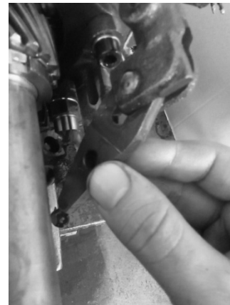
انگشتی میل ماهک دنده ۵ در آورید
