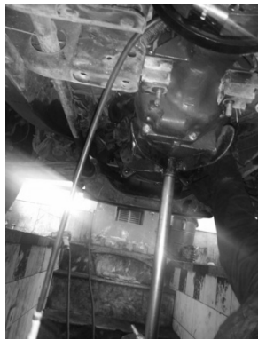
نصب گیربکس به موتور
