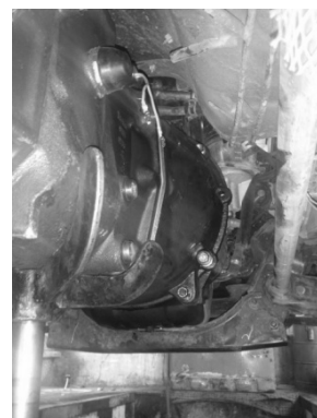
بستن پیچهای پوسته کلاچ به موتور خودرو
