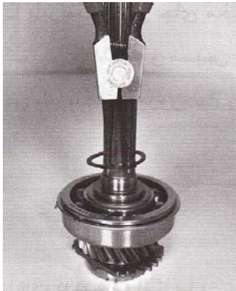
۱- خار نگهدارنده بلبرینگ را با خار باز کن بیرون آورید.
