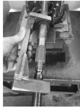
دنده حلزونی کیلومتر شمار را توسط پولی کش مخصوص در بیاورید.
