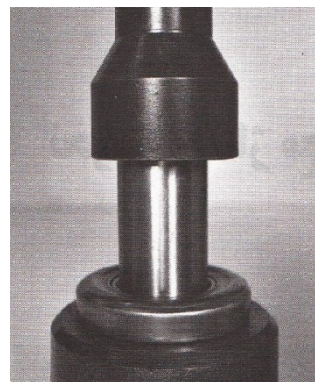
۴- بلبرینگ کلاچ را بوسیله فیکسچر مربوطه با پرس دستی یا هیدرولیکی بیرون بیاورید.
