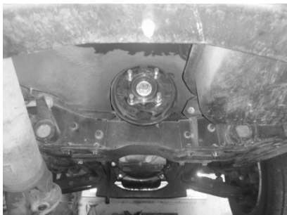
جدا کردن مجموعه گاردان از روی خودرو
