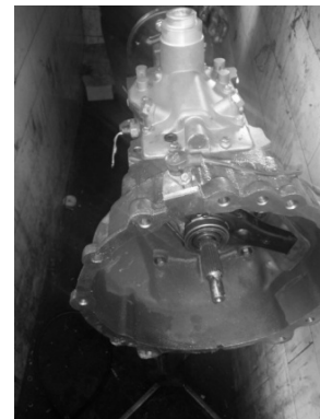
گذاشتن گیربکس روی جک مربوطه برای نصب روی خودرو
