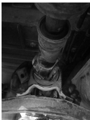
بستن پیچای تکیه گاه گاردان به شاسی
