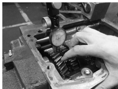
اندازه گیری لقی دنده با استفاده از ساعت اندیکاتور
