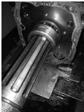
بلبرینگ شفت اصلی را با فیکسچر مخصوص در بیاورید
