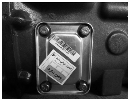
تزریق روغن بداخل گیربکس و چک کردن اندازه داخل گیربکس بوسیله پیچ تزریق
