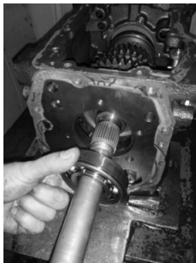
بلبرینگ شفت اصلی را با فیکسچر مخصوص در بیاورید
