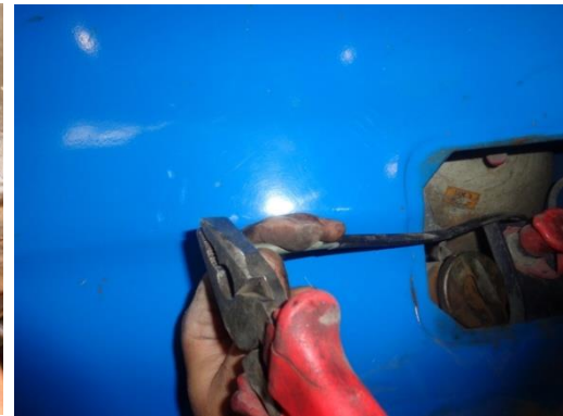
خارج نمودن سر دیگر لوله از درب محل سوخت گیری
