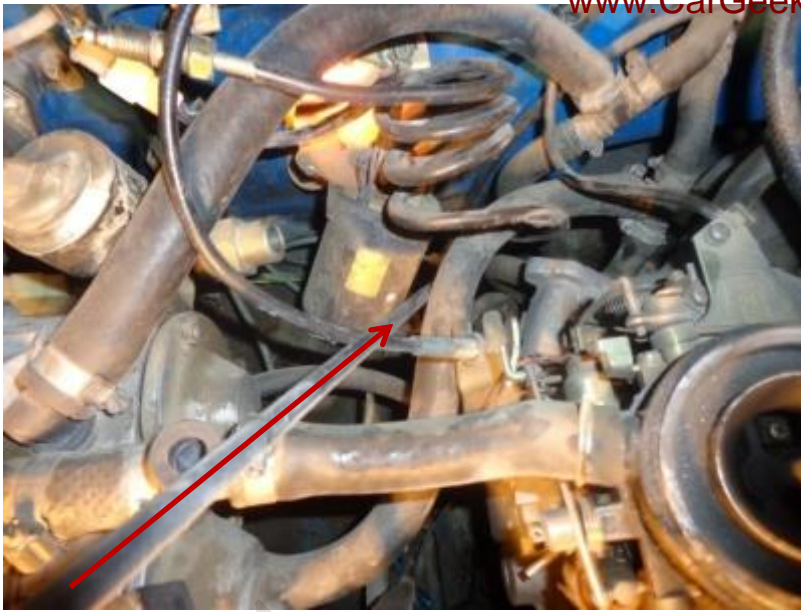
عبور دادن لوله انتقال گاز از سمت محفظه موتور به جهت فلش نشان داده شده در تصویر
