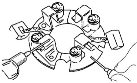
شکل ۲-۲۶: تست عایق پایه دغال
