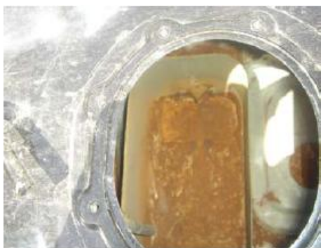
شکل شماره (۱۲) وجود زنگ آهن در داخل باک و روی فیلتر بنزین
