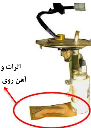
شکل شماره (۱۲) وجود زنگ آهن در داخل باک و روی فیلتر بنزین
