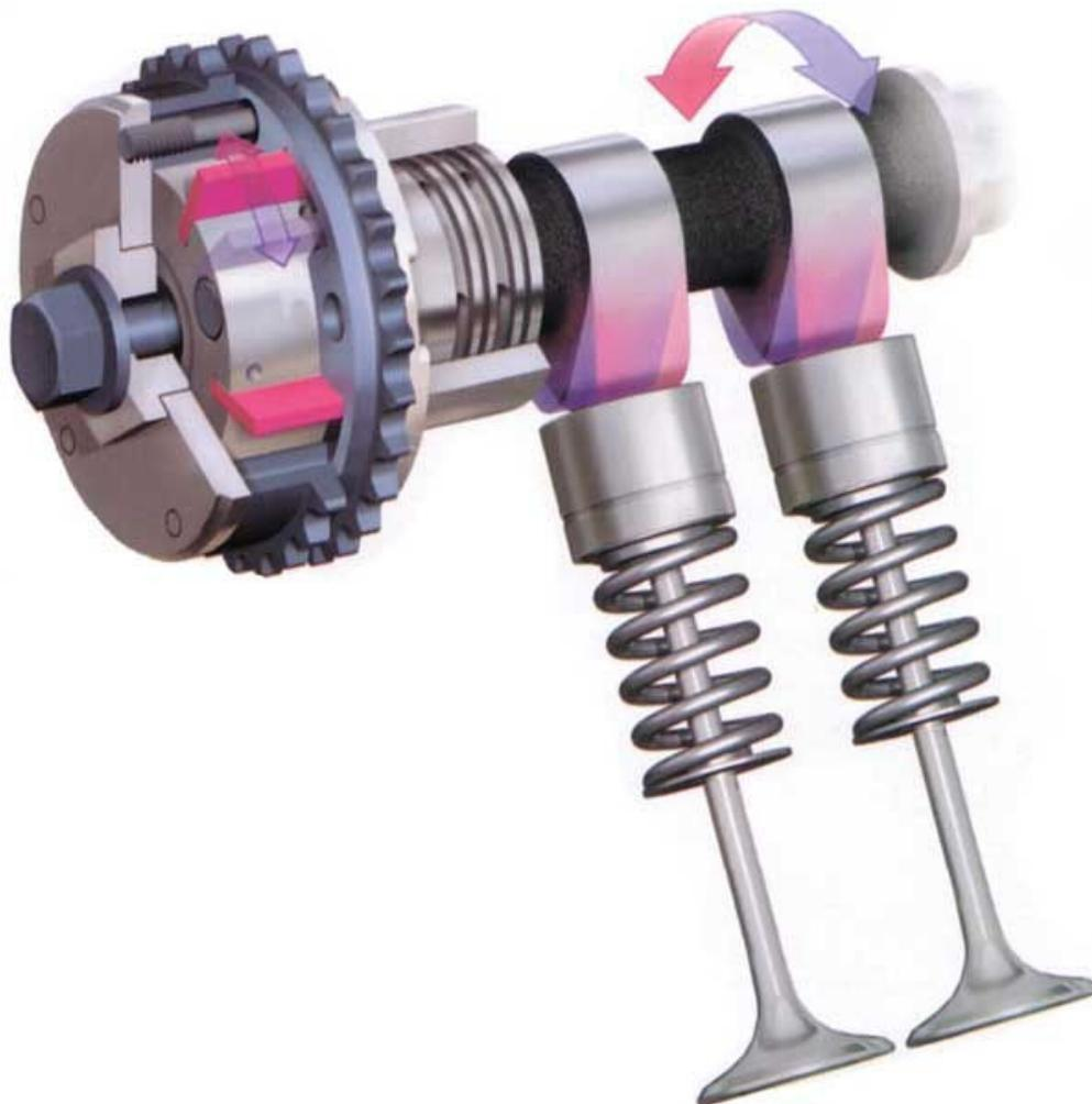
شکل (۳-۲۷) تغییر زاویه بادامک ها بوسیله فشار هیدرولیک
