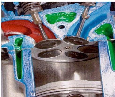
شکل (۲-۱۰) نمای برش خورده یک موتور پنج سوپاپه
