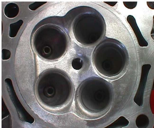
شکل (۲-۸) سرسیلندر موتور پنج سوپاپه فراری
