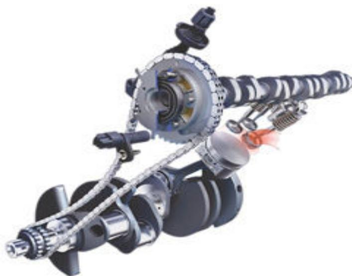
شکل (۲-۵) محل قرار گیری سوپاپهای دود و هوا
