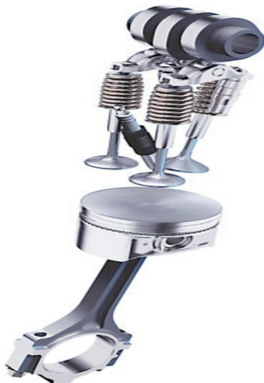
شکل (۲-۴) مکانیزم محرک سوپاپها
