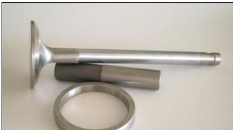
شکل(۱-۱) ساختار یک سوپاپ،نشیمنگاه وراهنما
