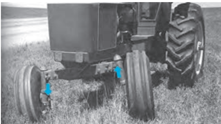
شکل ۳-۲- حالت الاکلنگی محور جلو در تراکتورهای چهارچرخ
