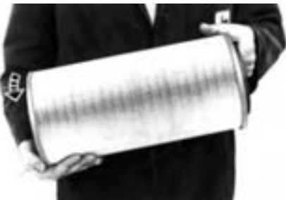
شکل ۱۱-۴- تمیز کردن استوانه صافی با ضربه
