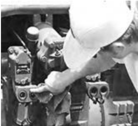
شکل ۱۱-۶- سرشیلنگی و مادگی را با پارچه تمیز کنید.
