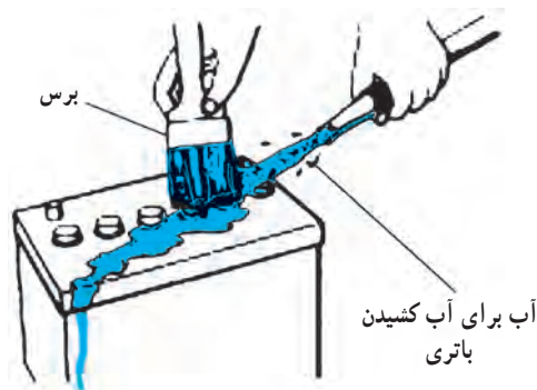
(ج) آب کشیدن باتری برای از بین بردن انزات جوش شیرین
