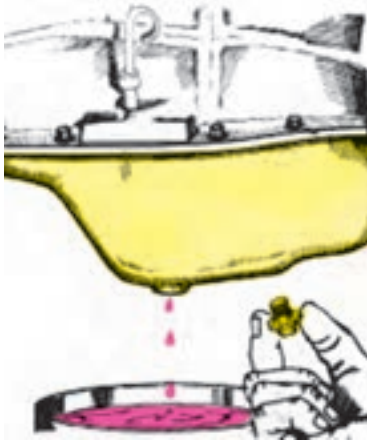
شکل ۳۳-۴- تخلیه روغن موتور
