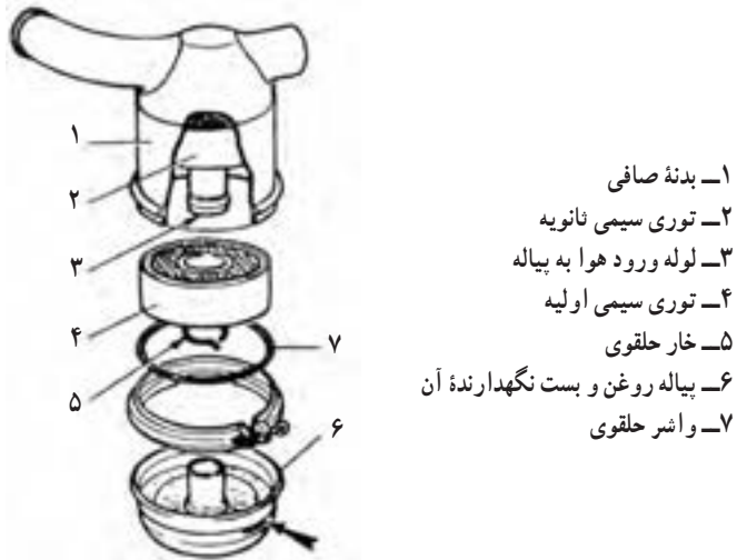
شکل ۳-۴ اجزای صافی هوا نوع روغنی
