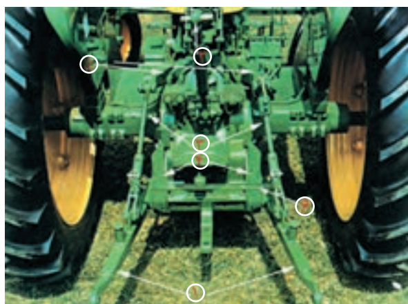
شکل ۳-۳ اجزای اتصال سه نقطه (در تراکتور JD ۳۱۴۰)
