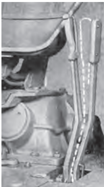
شکل ۷-۲- اهرم دیفرانسیل جلو (در تراکتور M ۶۵۰ U)
