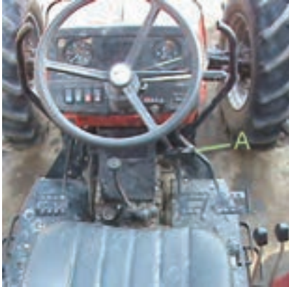
شکل ۲-۱- جفت کن پدال ترمز در تراکتور MF399
