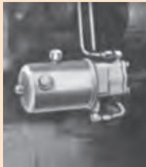
شکل ۲-۱۰- صافی پمپ فرمان در تراکتور MF۲۸۵
