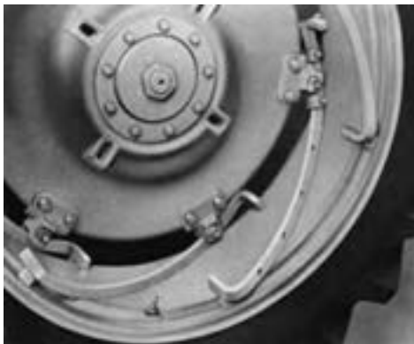
شکل ۱۳ - ۸ - اتصال دیسک به رینگ روی ریل
