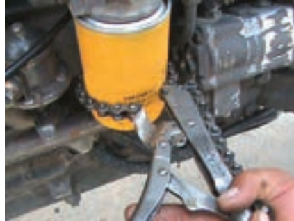
شکل ۳۴-۴- تعویض صافی روغن
