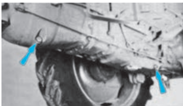
شکل ۳-۶ پیچ‌های تخلیه روغن هیدرولیک تراکتور MF ۲۸۵
