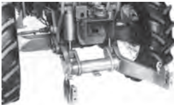
شکل ۲-۳ اتصال سه نقطه جلو (در تراکتور JD ۳۳۵۰)
