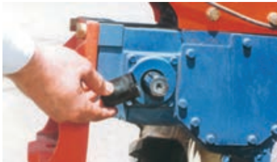
شکل ۹-۳- محور انتقال نیرو و درپوش روی آن
