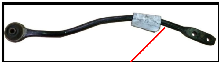
محل مناسب نصب تگ داغی
