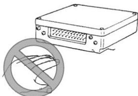
➤ دقت نمایید که ترمینال‌های واحدهای کنترل الکترونیکی مانند ECM ، TCM ، 4WD یونیت و غیره ( را با دست لمس ننمایید. الکتریسیته ساکن بدن شما میتواند به این اجزا صدمه وارد نماید
