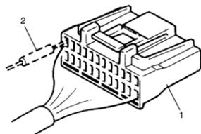
➤ در هنگام انجام عمل اندازه‌گیری روی کانکتورها، اطمینان حاصل نمایید که پراب دستگاه اندازه‌گیری (2) را از سمت سیم کشی (قسمت پشت) در کانکتور (1) فرو نمایید.
