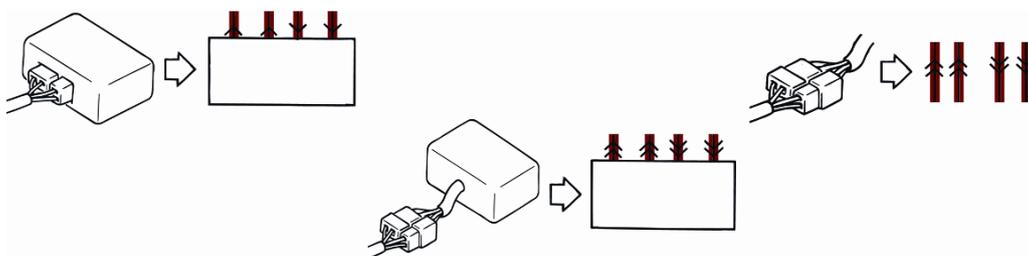
۳- ترمینال ها در یک کانکتور (خط شکسته) (B15) / ترمینال ها در کانکتورهای متفاوت (B14 و B16)
