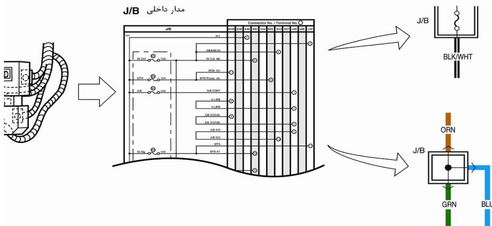
نحوه خواندن اتصالات بدنه از روی نقشه دسته سیم
