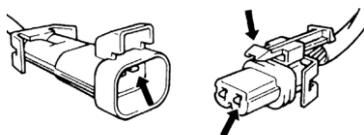
➤ کثیف شدن یا خوردگی ترمینال‌ها: ترمینال‌ها را باید از مواد خارجی که می‌توانند مانع اتصال صحیح شوند، تمیز نمود. از تمیز نمودن ترمینال‌ها بوسیله کاغذ سنباده و موارد مشابه اجتناب نمایید.
