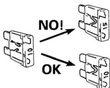
➤ در هنگام تعویض فیوز اطمینان حاصل نمایید که از فیوز با ظرفیت تعیین شده استفاده نمایید. استفاده از فیوز با ظرفیت بیشتر باعث صدمه دیدن اجزای الکتریکی و سوختن آنها می‌شود.
