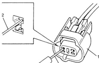
➤ در شرایطی که به دلیل عدم امکان نصب پراب اندازه‌گیری از قسمت پشت کانکتور، عمل اندازه‌گیری را از سمت ترمینال (2) کانکتور اتصال (1) انجام می‌دهید دقت نمایید که نیروی اعمالی باعث خم شدن پین‌های نری کانکتورها یا گشاد شدن محل‌های مادگی کانکتورها نشود. در مورد چنین کانکتورهایی برای جلوگیری از گشاد شدن ترمینال، پراب را مطابق شکل متصل نمایید.
