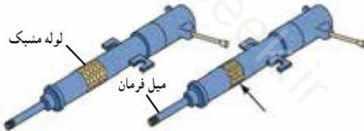
ستون فرمان پیش از تصادف
