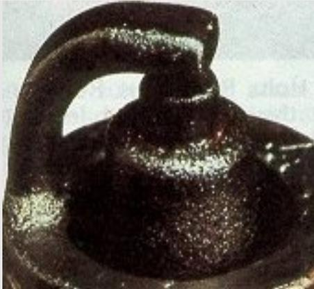
در این حالت الکترودها، دهانه عایق و پوسته شمع با دوده روشن و تخاله های کربن پوشیده می شود.
