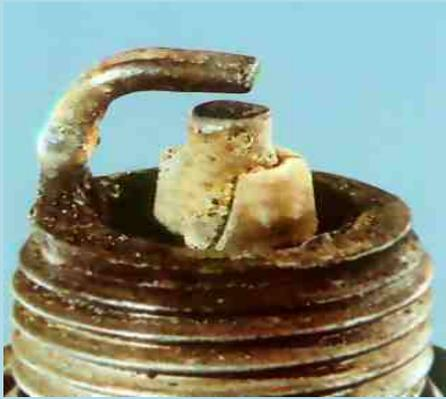
در این عایق الکتروود مرکزی شکسته و برق دزدی بین الکتروود مرکزی و بدنه شمع وجود دارد
