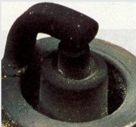
در این حالت الکترودها، دهانه عایق و پوسته شمع با رسوبات دوده به رنگ سیاه مخملی پوشیده می شود.
