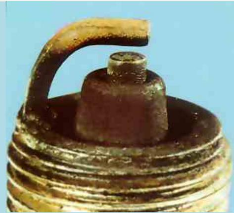
در این حالت الکترودها و عایق به رنگ خاکستری ~ زرد و متمایل به قهوه ای است در این شرایط رنج گرمایی شمع درست و دقیق بوده و موتور سالم عمل نموده است . وضعیت مخلوط و تایمینگ جرقه و سیستم شروع سرد (ساسات) کاملاً سالم بوده و هیچگونه رسوبات حاصل از افزایشده های سوختی شامل سرب و یا هرگونه ترکیبات آلیاژی در روغن موتور مشاهده نمی شود. احتراق بصورت کامل انجام شده و شرایط افروختگی (Over heat) وجود ندارد.
