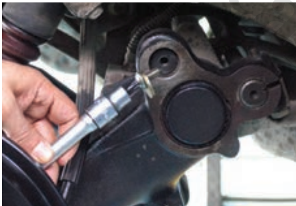
شکل ۱۷۶-۳- نصب واشر فشار و بیج‌های انتهای میله‌ها
