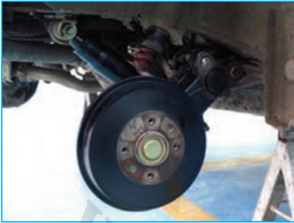
شکل ۱۸۳-۳- نصب ژامبون و متعلقات چرخ عقب
