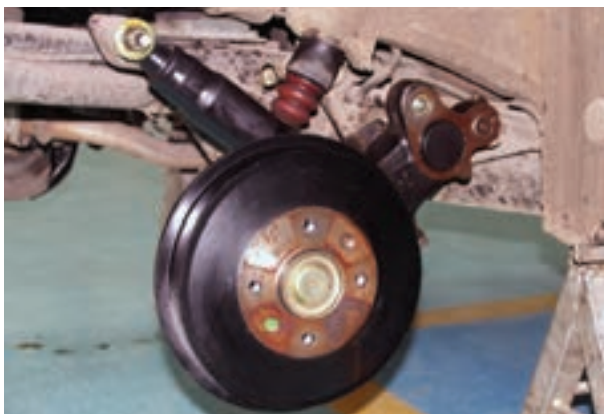
شکل ۱۷۷-۳- نصب کمک فنر
