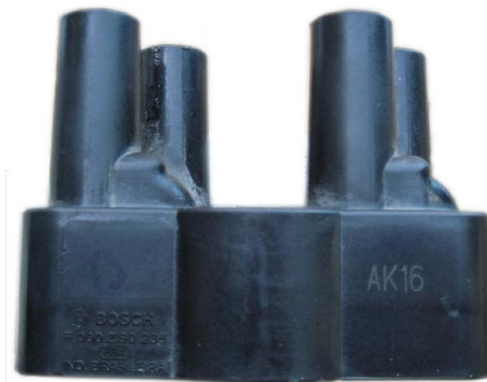
شکل شماره (۲) کویل مدل بوش
