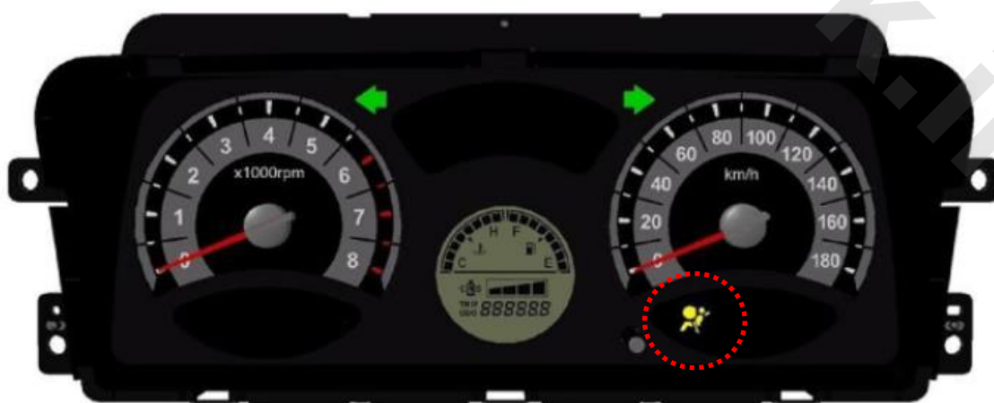
شکل شماره (۱۱) چراغ هشدار دهنده ایربگ در صفحه جلو آمپر (ایربگ Warning Lamp)
