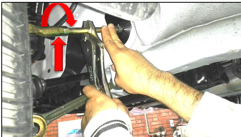
شكل شماره (۶) كنترل لقي سيك مياني (مفصل فرمان)
