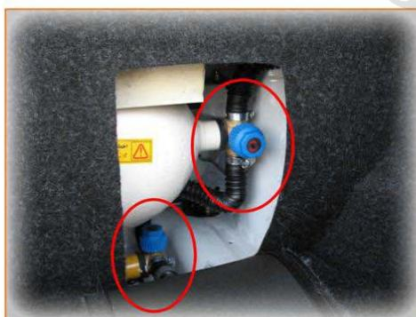
شیرهای مخازن را به مدت ۱ دقیقه بسته و سپس به آرامی باز کنید.
