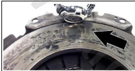
شکل شماره (۱۹) آینه شدگی ( براق شدگی )
