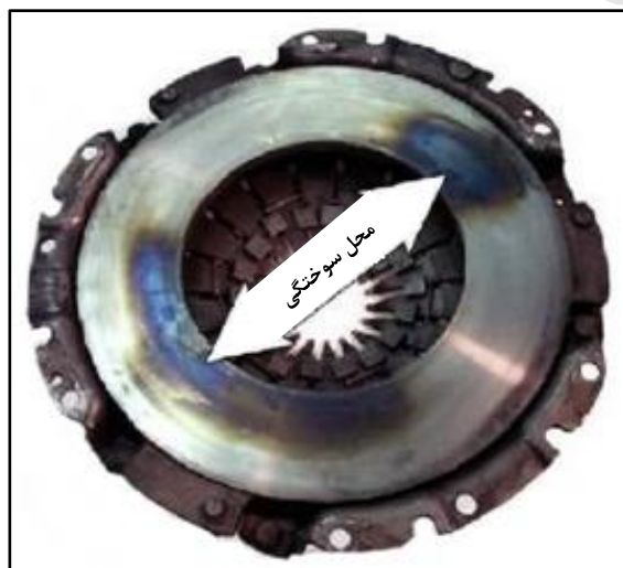
شکل شماره (۲۰) سوختگی یا تغییر رنگ مقطعی
