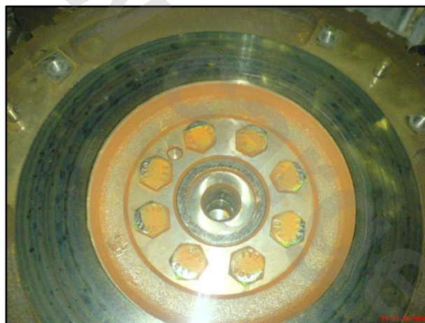
شکل شماره (۳۶) سوختگی سطح فلاپویل
