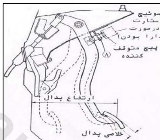
شکل شماره (۸) میزان خلاصی پدال کلاچ
