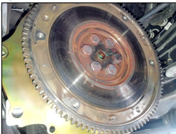
شکل شماره (۳۹) آثار کبودی یا سایش غیر یکنواخت
