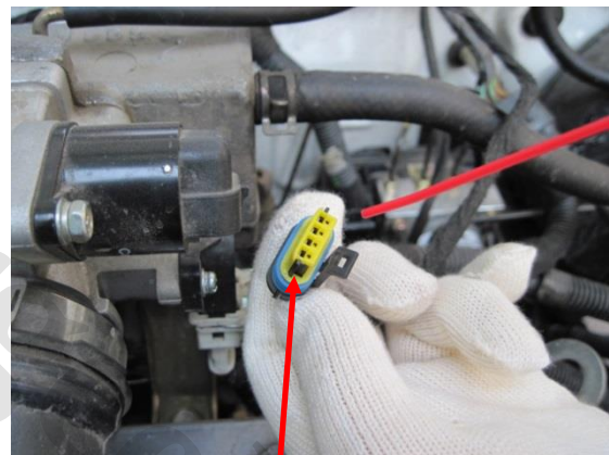
اسپری کردن کانکتورهای دسته سیم استپر موتور
