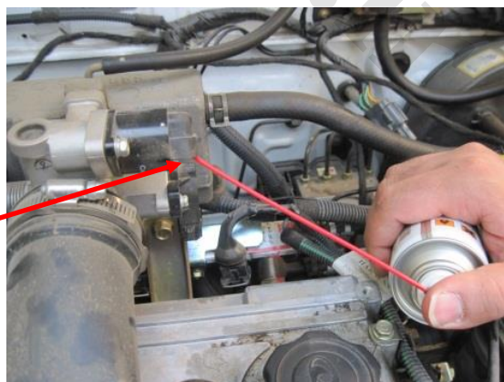
اسپری کردن کانکتورهای دسته سیم استپر موتور
