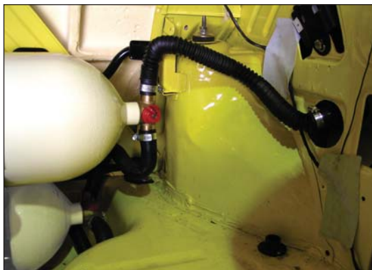
شیر سماوری و فیوز حساس به فشار
