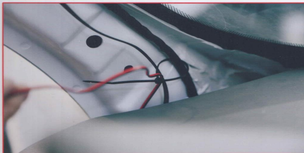
در قسمت پائین وقتی سیم آنتن را محکم می کنید سیم LED را نیز از بین بست کمر بند رد کنید تا از بالا محکم شود .
