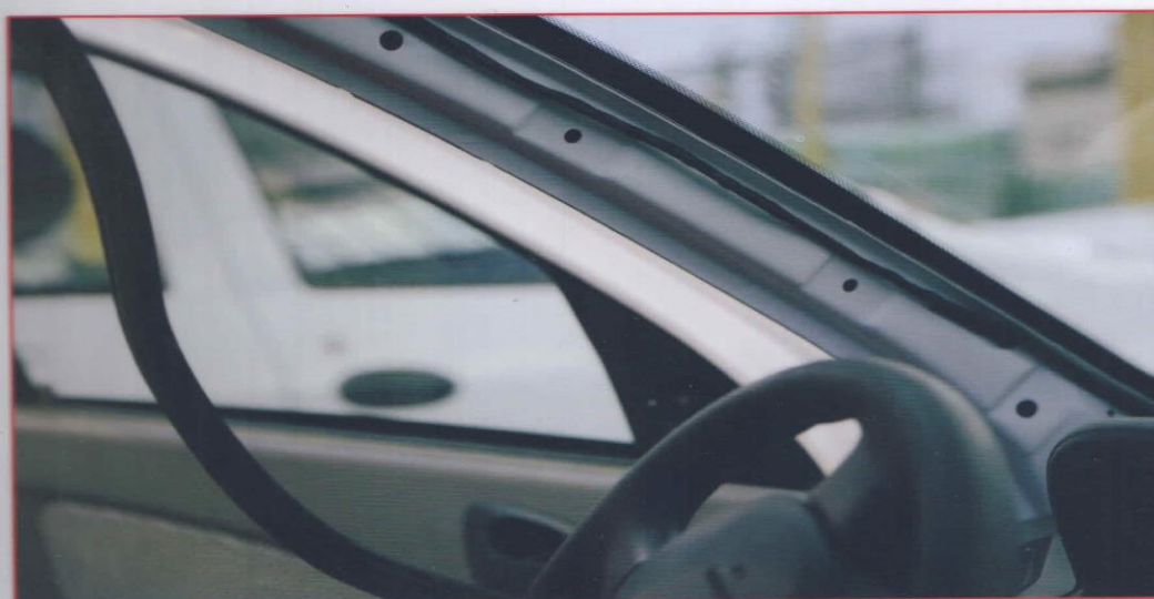
باز کردن قاب ستون سمت راننده جهت گذاشتن سیم های آنتن و چراغ LED
