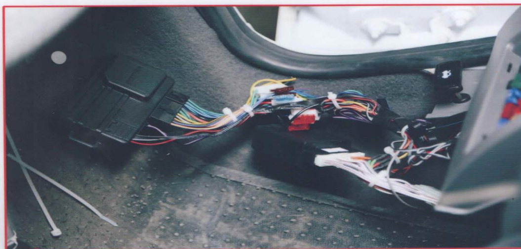
کیت نصب شده دزدگیر به روی سیم کشی فابریک
