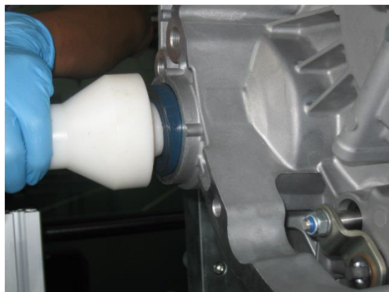
نصب کاسه نمد جدید به وسیله ابزار مخصوص
