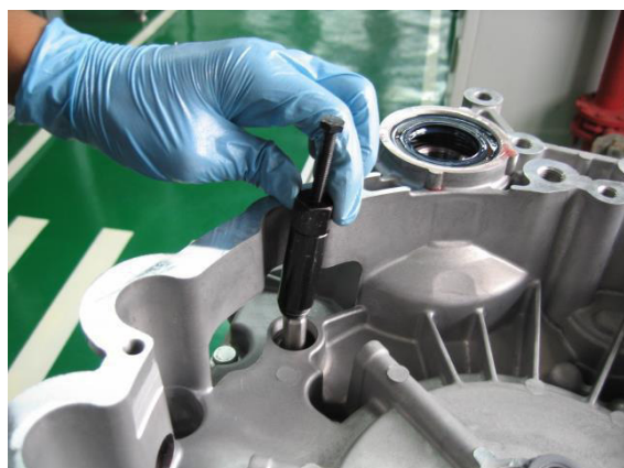
ابزار مخصوص 102970 را روی شفت قرار دهید
