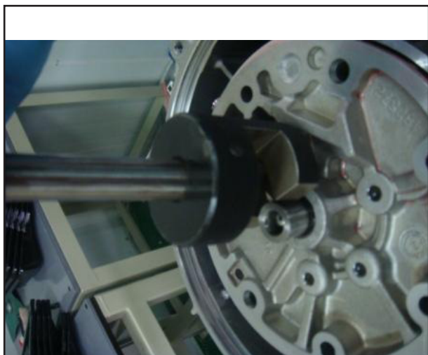
۶ عدد پیچ اوایل پمپ را باز نموده و ابزار مخصوص 102977 را نصب کنید
