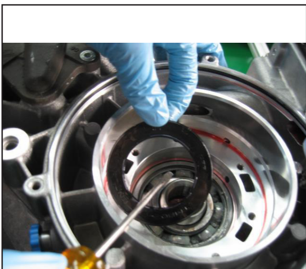
روکش بلبرینگ را بوسیله یک پیچ گوشتی کوچک بیرون آورید
