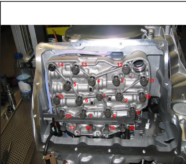
ترتیب باز و بست پیچ ها
