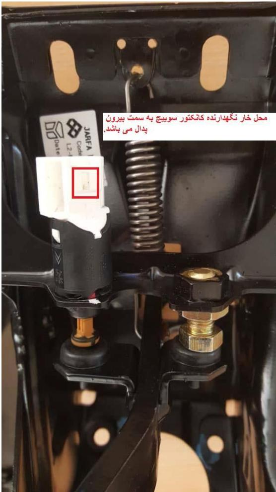
10- چند بار پدال ترمز را فشار داده تا از صحت عملکرد مکانیکی سوییج مطمئن شویم. (آیا کلاهک سوییج به صورت صحیح همزمان با فشردن پدال ترمز باز و بسته می شود یا نه) همچنین از رها کردن پدال ترمز اجتناب گردد. نیروی بیش از 11 N باعث صدمه دیدن سوییج پدال می گردد.
