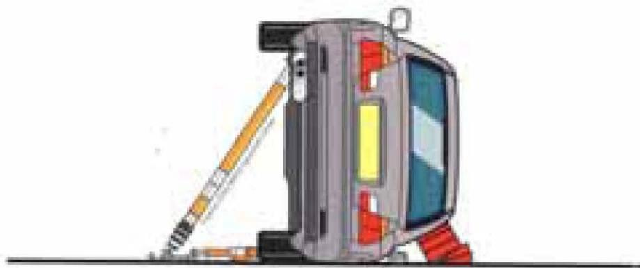
برای اطمینان از واژگون نشدن خودرو، با قرار دادن پایه هایی در نقاط A و C آنرا حمایت کنید. در کار خود دقت کنید، از قرار دادن وسایل ثابت سازی در محل هایی که احتمال بریده شدن آن است اجتناب کنید.
