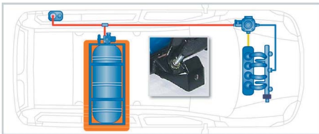
شکل ۲۷. بررسی نگهدارنده‌های مخزن CNG.
