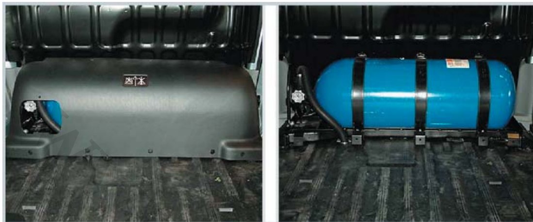
شکل ۱۲. مخزن CNG استوانه‌ای.
