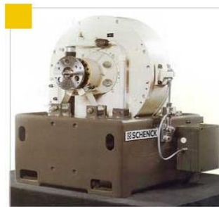
دینامومتر از نوع ادی کارنت با قدرت ۱۳۰ کیلو وات در شرکت ایران خودرو
