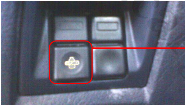
کلید تبدیل خودروی پارس دوگانه سوز با کیت گاز زمینس
