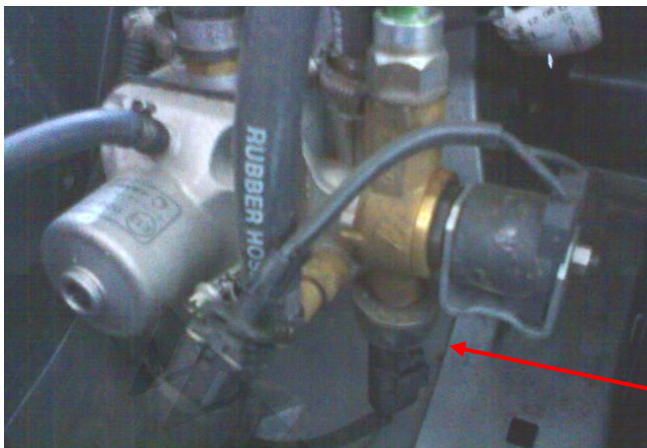
رگولاتور NG1 با سنسور فشار گاز پیزو الکترونیک
