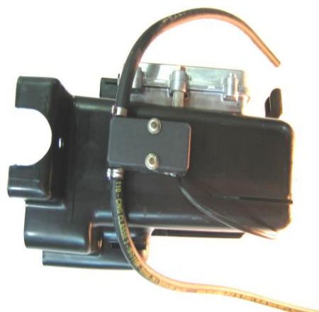
نصب سنسور سنسور فشار-خلاء روی جعبه ECU
