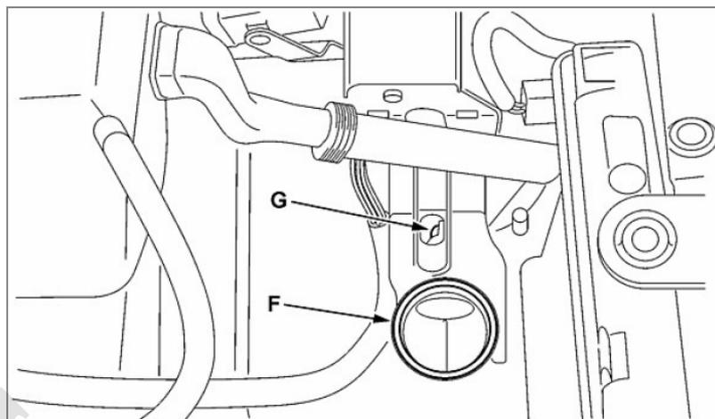
قبل از جا زدن فیلتر هوا و غیره کنترل نمائید که دقیقاً واشر (F) و قفل کننده (G) در وضعیت مطلوبی قرار داشته باشند.
