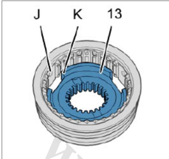
در موقع مونتاژ توپی و کشوئی 1 و 2 به شیار I روی توپی توجه گردد که در جهت شیار H روی کشوئی قرار گیرد. در هنگام مونتاژ به علامتی که هنگام باز کردن گذاشته اید و موقعیت نصب شیار (K) در کشوئی (J) در توپی توجه کنید.
