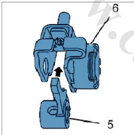
انگشتی درگیری (5) را در کلید قفل دنده (6) وارد کنید.
