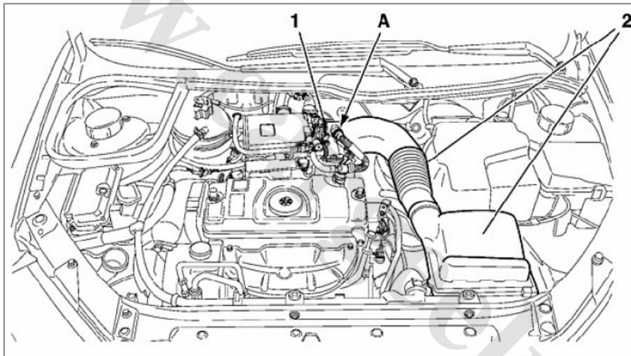
فیلتر هوا و لوله‌های هوا (۲) را پس از باز کردن بست‌های (A) و (۱) جدا کنید.
