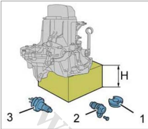
نگهدارنده کلاچ (1) را باز کنید ، سپس گیربکس را روی یک قطعه تخته چوب به ارتفاع 18 cm قرار دهید.
