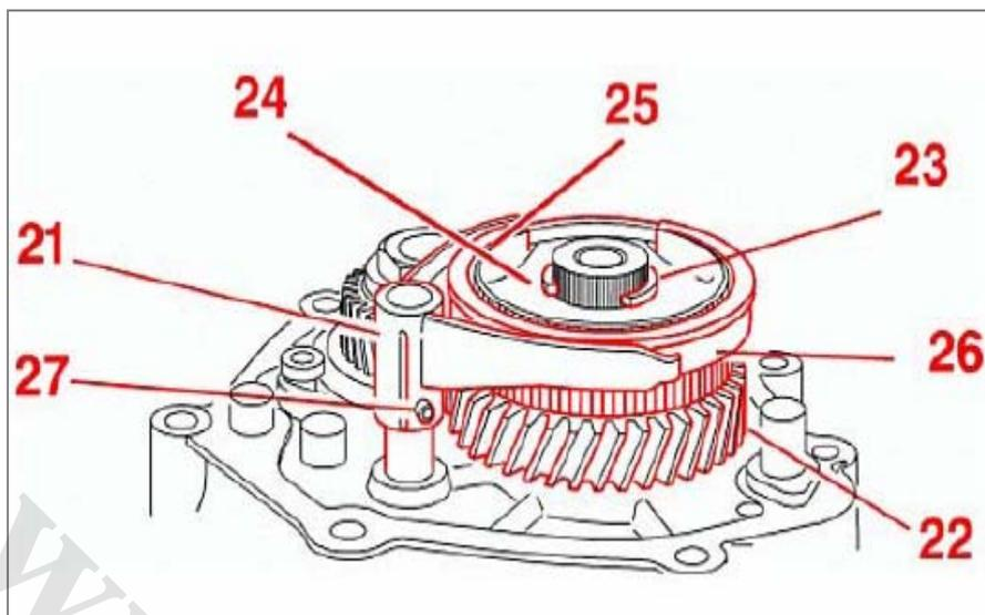
جازدن دنده ۵ ( بدون بلبرینگ سوزنی ) از تاریخ 2003/1 اعمال شده است.
