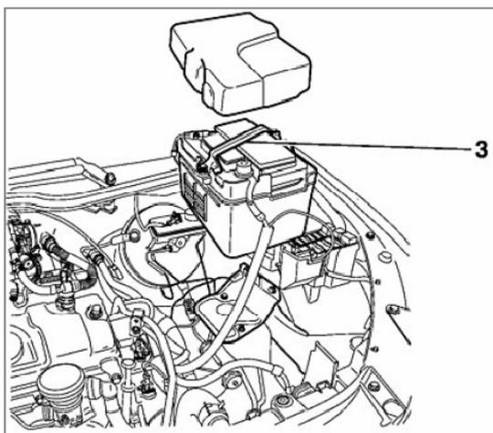
بست (1) را بر اساس نوع آن با استفاده از ابزار بست شیلنگ [2] یا پیچ گوشتی باز کنید و سپس لوله بخارات روغن (A) را باز کرده و فیلتر هوا (2) و لوله آن را باز کنید. باتری و بست های باتری (3) را باز کرده و باتری را از روی سینی نگهدارنده باتری بیرون بیاورید.
