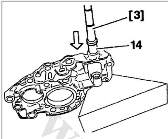
پوسته میانی را روی یک قطعه چوب (به ابعاد ۲۵۰×۵۰×۹۵ سانتیمتر) قرار دهید. سپس بلبرینگ، سوزنی (13) را با استفاده از ابزار [3] خارج کنید.
