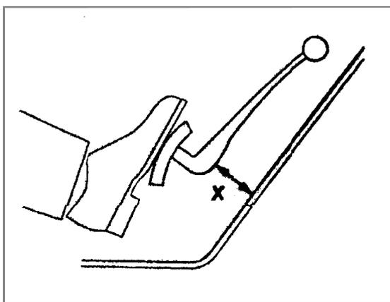
سپس چندین مرتبه و به سرعت پدال کلاچ را حرکت دهید موتور را روشن، ترمز دستی را کشیده و دنده را درگیر کنید، سپس پدال کلاچ را کم کم رها کنید. زمان شروع کلاچ گیری فاصله X مساوی و یا بیشتر از ۳۰mm باشد.
