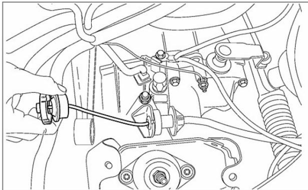
سیم کلاچ را با استفاده از دست بکشید تا از روی اهرم کلاچ باز شود.
