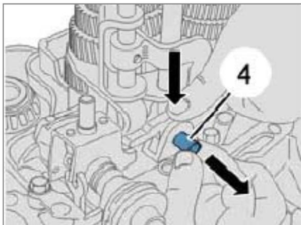
۳- سپس مطابق شکل با فشار دادن اهرم ماهک دنده عقب به سمت پائین و خارج کردن پین (4)، ماهک دنده عقب آزاد میگردد.
