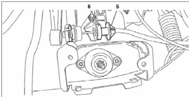
انتهای پوسته سیم کلاچ (5) و کائوچویی سیم کلاچ (6) را به ترتیب باز کنید و سپس متعلقات نگهدارنده سیم کلاچ را از روی اهرم کلاچ جدا سازید.
