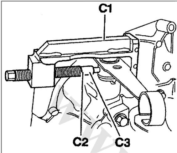
ابزار [2] را روی اهرم دو شاخه کلاچ قرار دهید و با استفاده از ابزار [C1] و [C2] و [C3]، یک پین جدید را جا بزنید.
