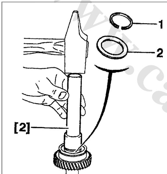
سپس واشر فاصله انداز (2) و خار فنری (1) بر روی شافت قرار دهید و با استفاده از ابزار [2] بر روی شافت مونتاژ کنید.
