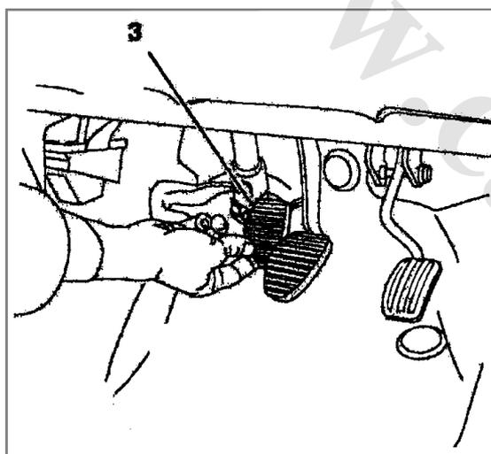
مطابق شکل اگر حرکت سیم کلاچ به اندازه  $y \geq 24\text{mm}$  باشد تنظیم است و اگر مقدار Y کمتر از حد مجاز فوق باشد سیم کلاچ را تعویض کنید.
