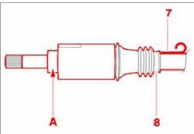
گردگیر را در موقعیت آن قرار داده و آنرا نسبت به علامت درج شده بر روی آن که در زمان باز کردن نشان گذاری شده است تنظیم کنید یا در موقعیت شیار آن قرار دهید.
