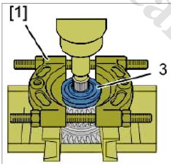
با استفاده از ابزار [1] و پرس هیدرولیکی، بلبرینگ (3) را خارج کنید.
