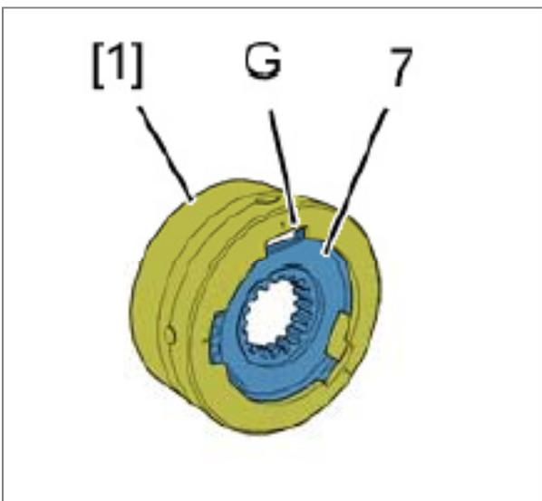
موقعیت شیار (G) روی توپی (7) و موقعیت سوراخ شماره (1) را توسط ابزار جا زدن دنده برنجی، جا بزنید.
