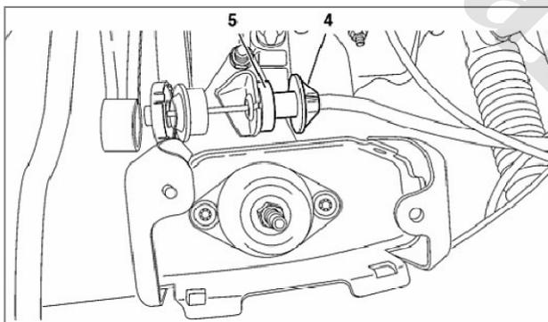
سپس پوسته و قسمت انتهایی سیم کلاچ (4) و کائوچویی سیم کلاچ (5) را مطابق شکل باز کنید. سپس متعلقات نگهدارنده سیم کلاچ را از روی پوسته گیربکس جدا کنید.
