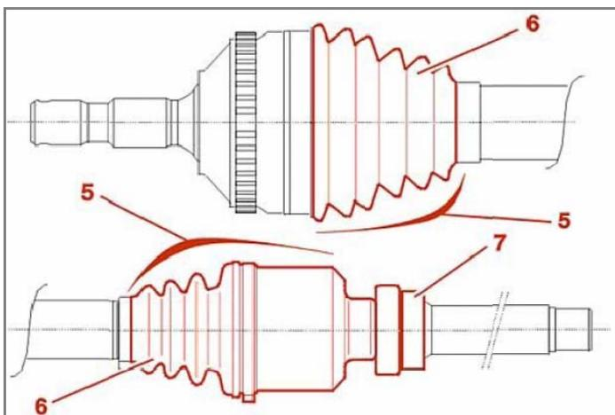
پس از تمیز کردن، هزار خاری دوسر پلوس و توپی آن همچنین هزار خاری دنده های خورشیدی دیفرانسیل ر ابا گریس مولتی پرپوز TOTAL 3945 آغشته نمائید.
