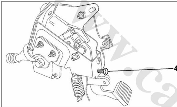
اگر روش فوق امکان پذیر نباشد و مکانیزم بطور اتوماتیک نصب شده باشد، پیچ (4) را شل کنید تا حداقل فاصله در پدال کلاچ ایجاد شود.
