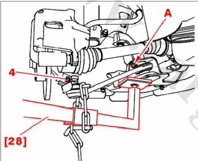
پیچ (4) را باز کنید و سیبک را به وسیله ابزار مخصوص [3] (اهرم سیبک کش) جدا کنید.
