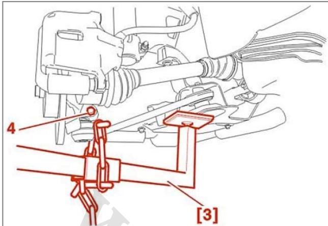
پلوس را در توپی دیسک چرخ جا بزنید. سپس سیبک را توسط ابزار مخصوص [3] جا بزنید و پیچ [4] را به اندازه  $4 \text{ daN.m}$  سفت کنید. ابزار مخصوص [3] را باز کنید.
