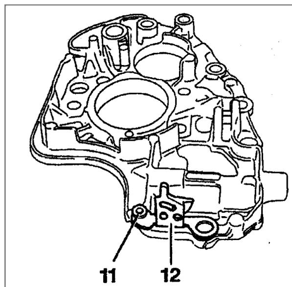
مکانیزم قفل دنده 5 و دنده عقب (12) را نصب کنید، سپس با استفاده از انبر پرچ کن، پرچ (11) را جا بزنید.
