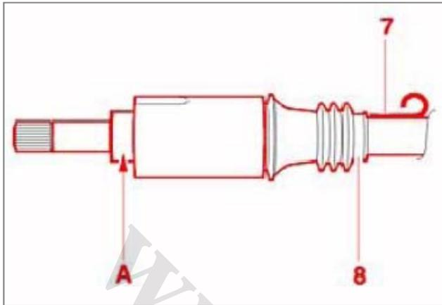
گردگیر را در موقعیت آن قرار داده و آنرا نسبت به علامت درج شده بر روی آن که در زمان باز کردن نشان گذاری شده است تنظیم کنید.
