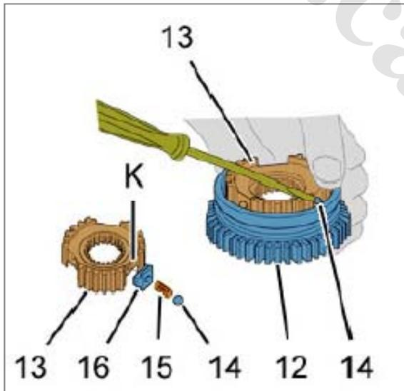
خار موشکی (16) را قرار داده و آنرا نگهدارید، سپس فنر را جا بزنید. ساچمه (14) را روی فنر قرار داده و توسط پیچ گوشتی روی ساچمه فشار وارد آورید تا بین فنر (15) و کشوئی (12) قرار گیرد.
