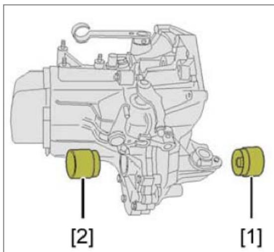
با استفاده از ابزارهای جازن [1],[2] کاسه نمدهای طرفین دیفرانسیل را جا بزنید
