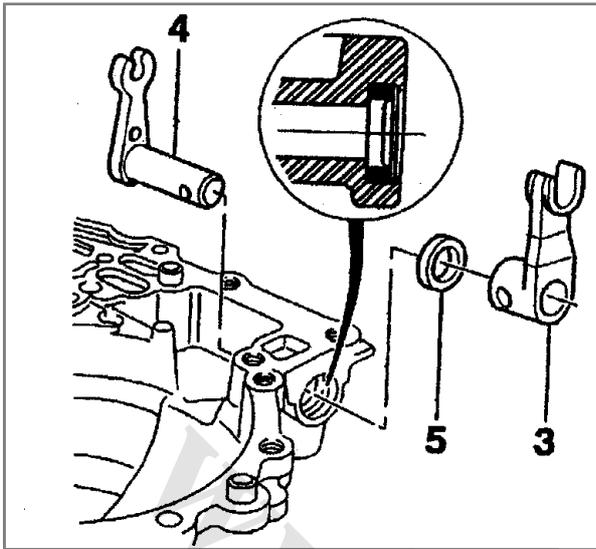
جا زدن اهرم تعویض دنده:
