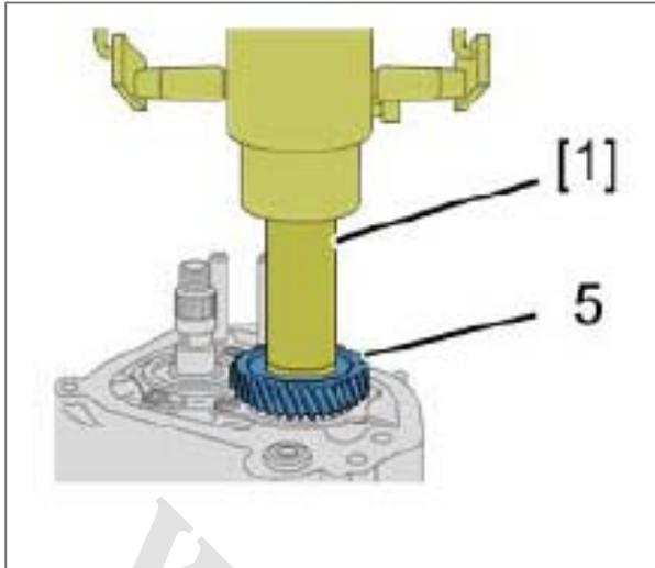
چرخندهٔ محرک دنده (5) را با استفاده از ابزار مخصوص [2] و پرس جا بزنید.
