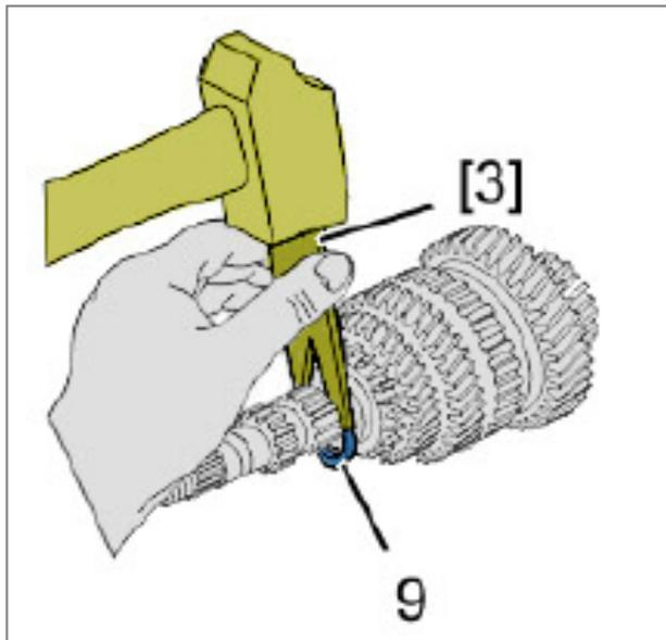
با استفاده از ابزار خاردار آر [3] و چکش، خار فنری (9) را از روی شافت جدا کنید.
