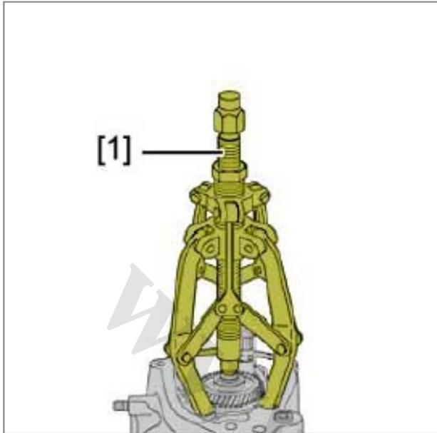
سپس دنده روی شافت ورودی را با استفاده از ابزار [1] جدا کنید.
