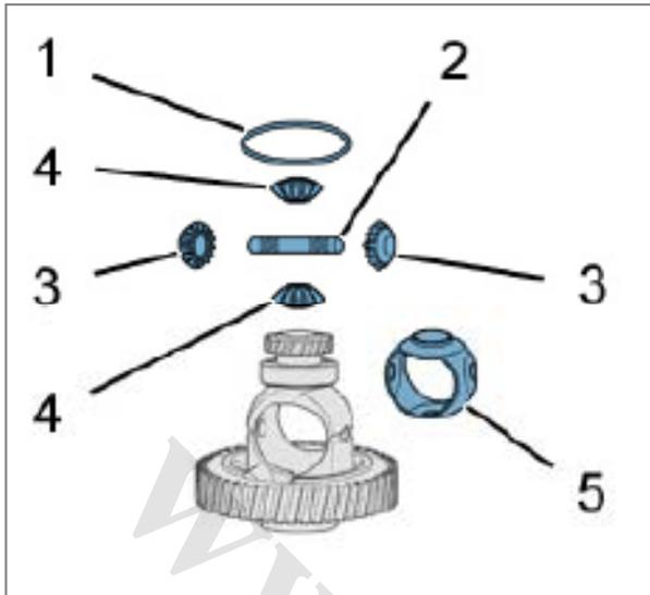
باز و بست دیفرانسیل :
