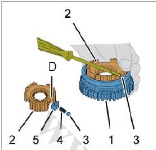
خار موشکی (5) را قرار داده و آنرا نگهدارید، سپس فنر را جا بزنید. ساچمه (3) را روی فنر قرار داده و توسط پیچ گوشتی روی ساچمه فشار وارد آورید تا بین فنر (4) و کشوئی (1) قرار گیرد.
