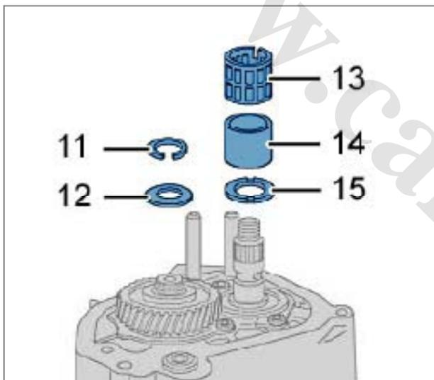
ابتدا در خار حلقوی (11) و واشر شافت (12) را از روی شافت ورودی جدا کنید. سپس بلبرینگ سوزنی (13)، بوش فاصله انداز (14) و واشر فاصله انداز (15) را از روی شافت خروجی بیرون بیاورید.
