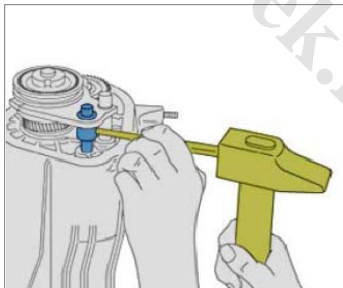
سپس با استفاده از یک سمبه، بین ماهک را از میل ماهک دنده پنج جدا کنید.
