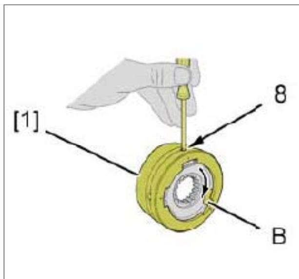
سپس ساچمه (8) را در داخل سوراخ قرار دهید و سپس توپی را در داخل ابزار مخصوص بچرخانید. از شماره های حک شده روی ابزار مخصوص پیروی کنید.
