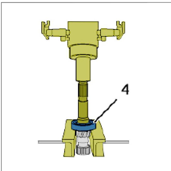
با استفاده از ابزار مخصوص مورد نیاز مطابق شکل میتوان چرخنده های شافت ورودی را کاملاً باز نمود. روش کار به ترتیب ذیل میباشد:
