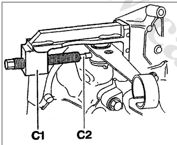
برای کامل جا زدن پین دو شاخه کلاچ، از ابزار [C2] استفاده کنید.
