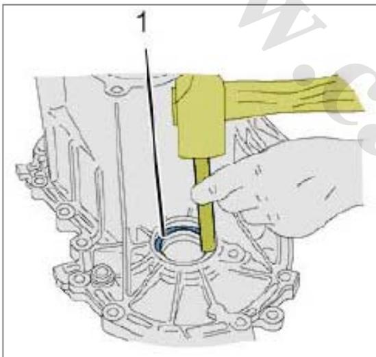
کنس بلبرینگ سمت چپ دیفرانسیل (1) را
