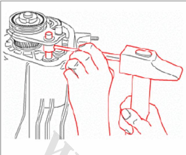
ماهک دنده پنج را با استفاده از یک پین فلزی نو مطابق شکل روبرو محکم کنید.
