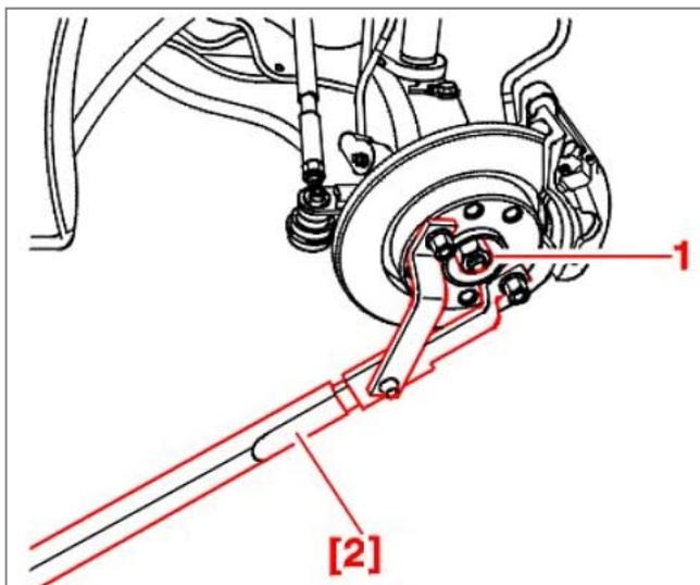
روی مهره (1) را با گریس "MOLYKOTE D321R" گریسکاری کنید. مهره (1) را به اندازه  $24/5 \text{ daN.m}$  سفت کنید برای اینکار از ابزار مخصوص [2] استفاده کنید سپس پین آن را توسط سمبه [6] جا بزنید.
