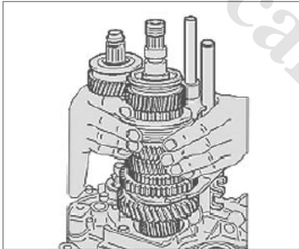
مطابق شکل، مجموعه شافت ورودی، شافت خروجی، ماهکها و میل ماهکها را با همدیگر و بصورت یک مجموعه از روی پوسته زیرین گیربکس جدا کنید.
