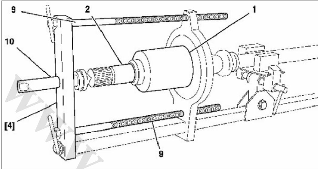
پلوس را مطابق شکل داخل ابزار مخصوص [4] جا بزنید و چین گردگیر دور بدنه را طبق روش گفته شده در روش اول باز کنید. در ابتدا برای جازدن گردگیر و جمع کردن آن از پیچ (9) استفاده کرده و اتصال داخلی (2) را فشار داده و به آرامی پیچ (10) را ببندید و گردگیر را جمع کرده و آنرا چین بدهید و طبق مراحل روش اول کار را ادامه دهید.
