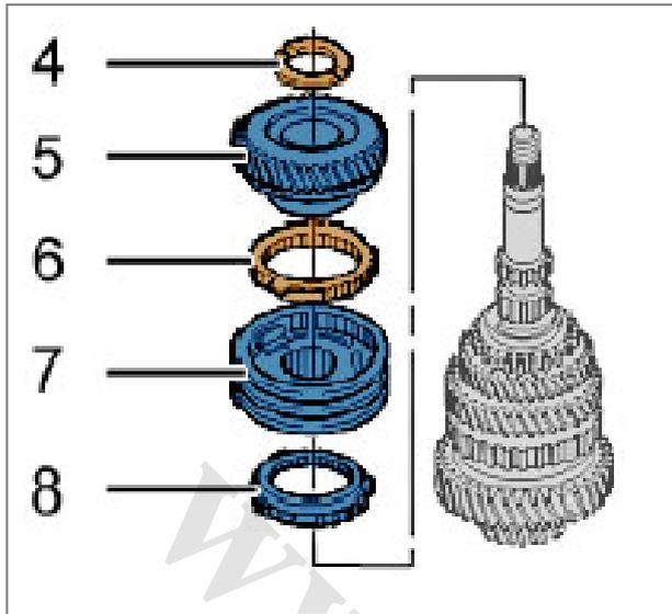
واشر دنده (4) و همچنین چرخ دنده متحرک دنده چهار (5) را جدا کنید. دنده برنجی (6) مربوط به دنده چهار و کشوئی و توپی (7) و دنده برنجی (8) مربوط به دنده سه را از روی شافت خارج کنید. توجه داشته باشید که کشوئی و توپی را از همدیگر جدا نکنید، تا از پرتاب شدن ساچمه ها و فنرها و راهنماها جلوگیری گردد.
