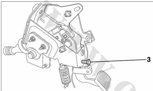
اگر روش مذکور امکان پذیر باشد و مکانیزم بطور اتوماتیک نصب باشد. پیچ (3) را شل کنید تا حداقل فاصله در پدال کلاچ ایجاد شود.
