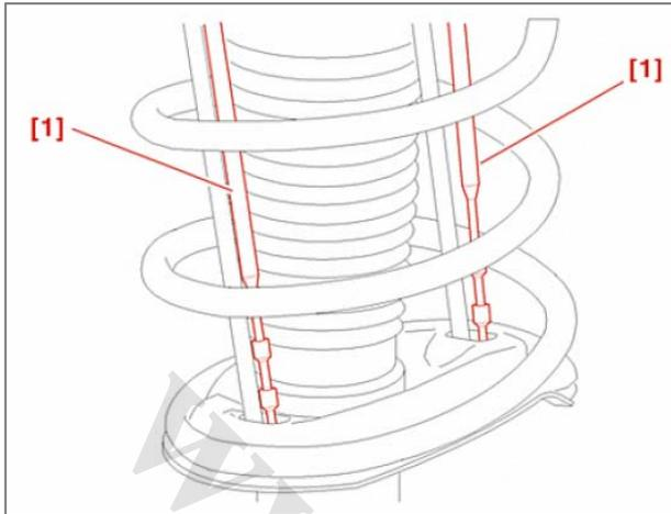
برای راحتی کار یک چرخ را بلند کنید ابزار مخصوص [1] را داخل فنر جا بزنید. (بمنظور اطلاع از چگونگی عملکرد این ابزار مخصوص به کتاب سیستم تعلیق مراجعه کنید). این عمل باعث نگه داشتن سیستم فنر و تعلیق آن خواهد شد. سپس چرخ را باز کنید.
