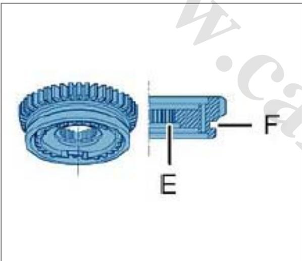
برای نصب توپی و کشوئی، دنده (1) و (2)، شیار (E) توپی، باید هم جهت با سمتی که محل قرار گرفتن ماهک (F) روی کشوئی است، قرار گیرد. اگر در هنگام باز کردن علامتگذاری کرده اید، حتماً به علامت آن توجه کنید.
