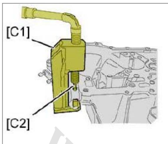
۲-۹) باز کردن اهرم تعویض دنده:
