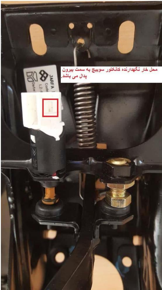
10- چند بار پدال ترمز را فشار داده تا از صحت عملکرد مکانیکی سوییج مطمئن شویم. (آیا کلاهک سوییج به صورت صحیح همزمان با فشردن پدال ترمز باز و بسته می شود یا نه) همچنین از رها کردن پدال ترمز اجتناب گردد. نیروی بیش از N 11 باعث صدمه دیدن سوییج پدال می گردد.
