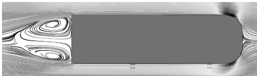
شکل ۸ نمایش بردار سرعت در نقاط مختلف بدنه
