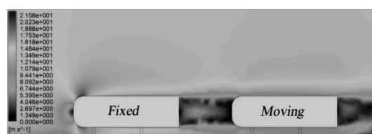
شکل ۱۲ کانتور سرعت جریان در x/l = 0.5
