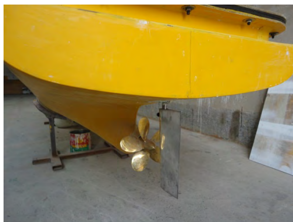
شکل ۱۴: نصب پروانه و سکان بر روی بدنه
