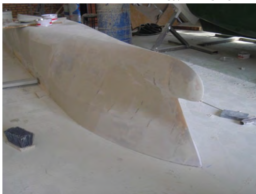
شکل ۱۰: مدل کامپوزیت پس از خروج از قالب
