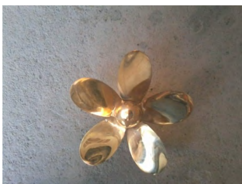
شکل ۱۱: پروانه برنجی ساخته شده توسط ماشین CNC
