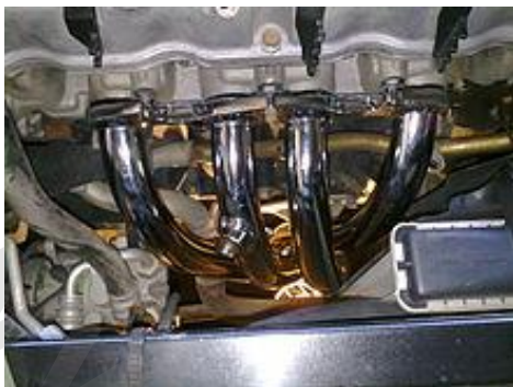
شکل ۱. دو نمونه از هدرزهای طراحی و ساخته شده.
