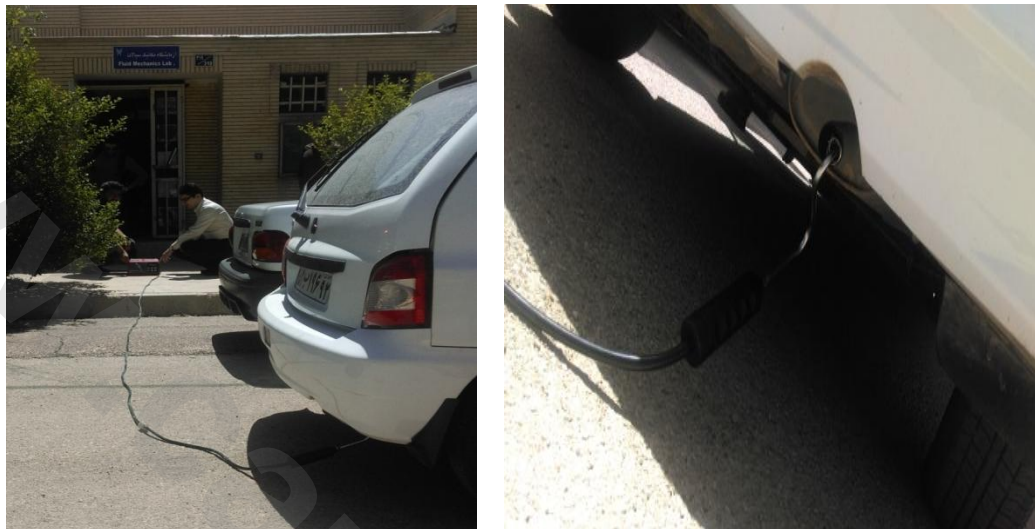
شکل ۳. تصاویری از مراحل داده برداری توسط دستگاه تست ۵ گاز.
