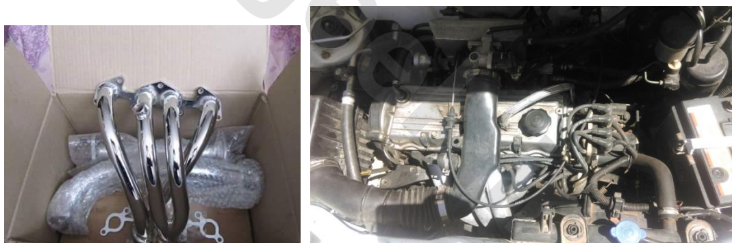
شکل ۴. تصاویری از هدرز استفاده شده و نصب شده بر روی موتور پراید.
