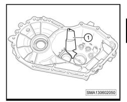
11. Remove the baffle (-1-).
