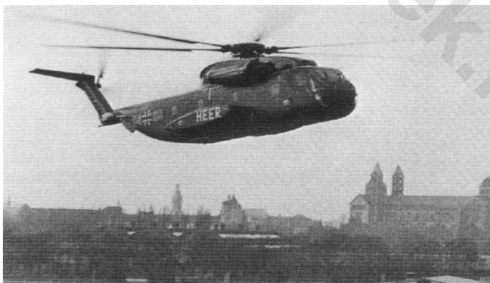
شکل ۲۱-۱ هلیکوپتر Sikorsky CH-53G با دو موتور توربوشتفت T64 ساخت شرکت General Electric.
