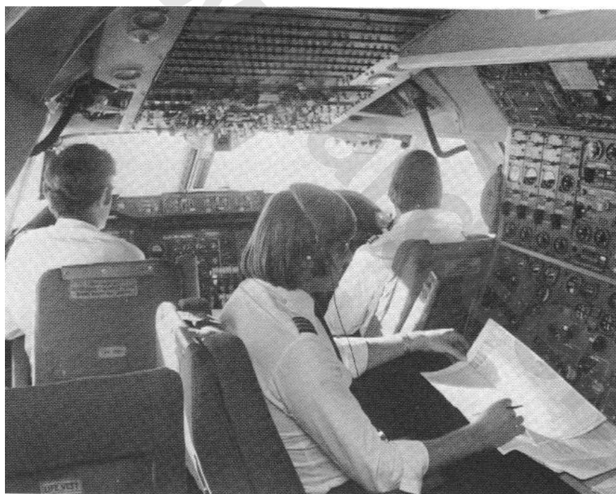
شکل ۹-۱۴ در زمان اتاق های خلبانی سه نفره ، این وظیفه ی مهندس پرواز بود تا سیستم های موتور و سوخت را ملاحظه کند (بوئینگ قدیمی ۷۴۷)
