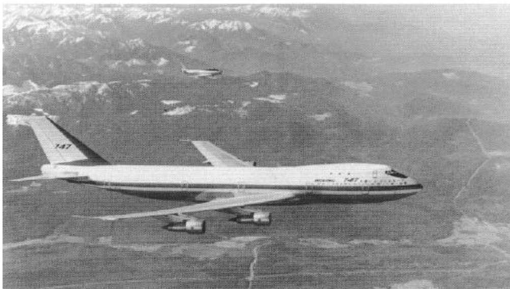
شکل ۱-۱۷ بوئینگ ۷۴۷ که قدرت خود را از چهار توربوفن با نسبت کنار گذاری بالا Pratt & Whitney JT9D-7 فراهم می شود
