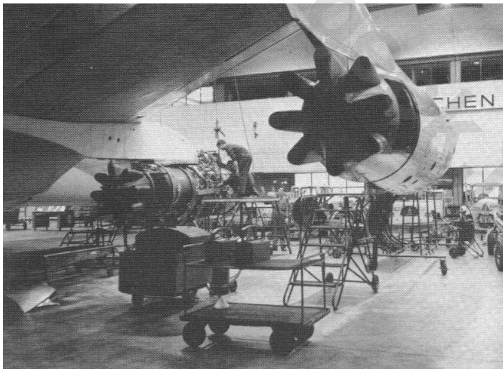
شکل ۴-۱۰ جلوگیرنده ی سر و صدا به کار رفته در بوئینگ ۷۰۷ در دهه ی هفتاد
