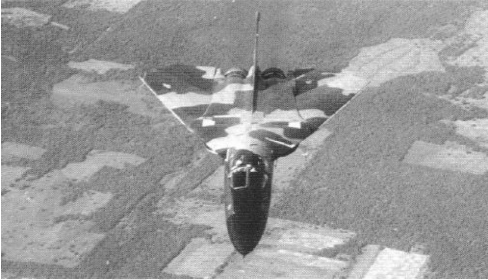
شکل ۱-۱۱ هواپیمای جنگی General Dynamics F-111 که نیروی خود را از دو توربوفن Pratt & Whitney Tf30-P-7 فراهم می کند.
