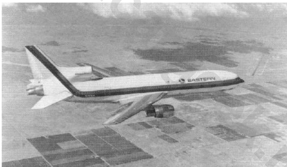
شکل ۱-۱۸ Lockheed TriStar ۱۱۱ با سه توربوفن RB211 با نسبت کنار گذاری بالا ساخت شرکت رولزرویس
