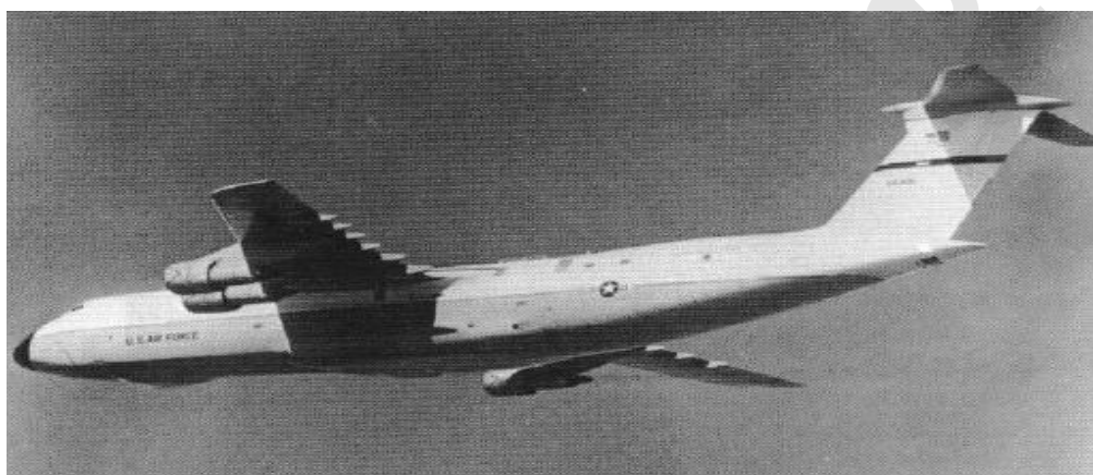
شکل ۱۴-۱ Lockheed C-5A هواپیمای حمل و نقلی ارتشی که نیروی خود را از چهار توربوفن با نسبت کنارگذاری بالای TF39 شرکت General Electric می گیرد.
